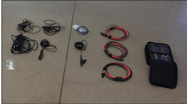
Figura 3.4. Equipo de medición de calidad de energía AEMC Power Pad II (Elaboración Propia).
