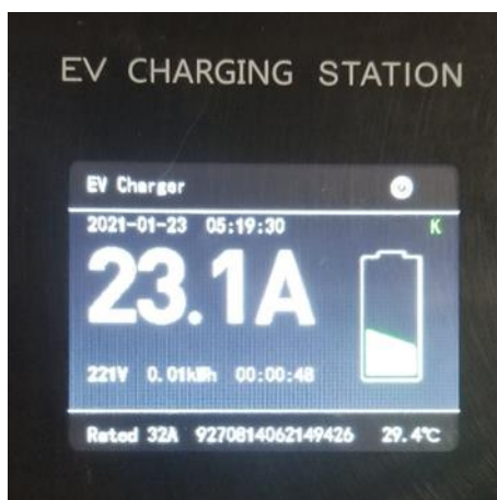
Figura 4.8 Estado D del Proceso de Carga: a) Estación Suministrando Energía, b) Pantalla HMI en Proceso de Carga
