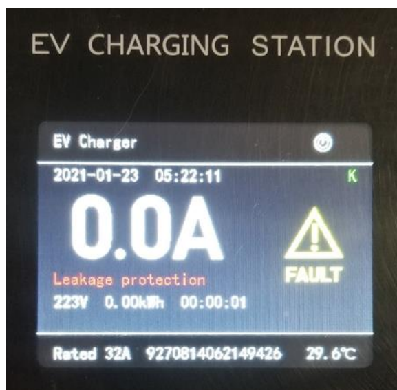
Figura 4.27 Estado de Error en la EVSE, Protección Contra Fugas de Corriente
