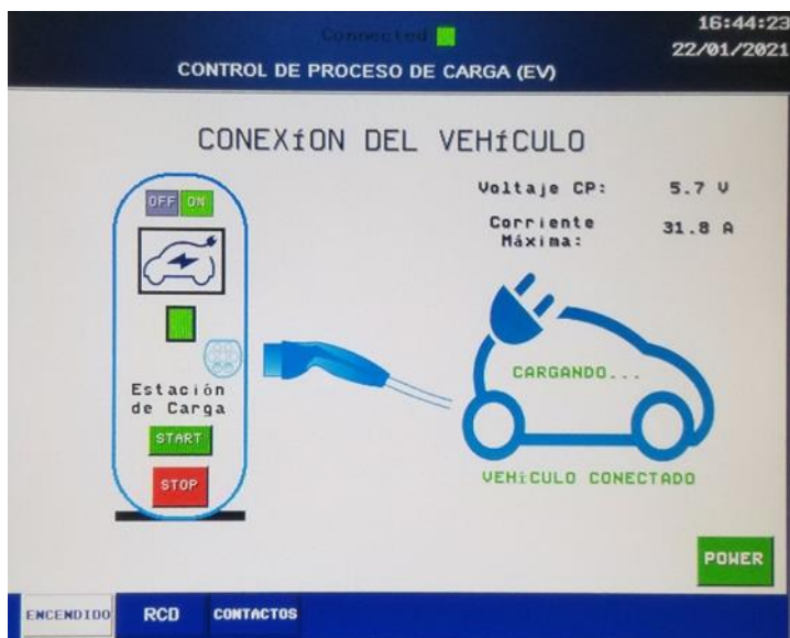
Figura 4.8 Estado D del Proceso de Carga: a) Estación Suministrando Energía, b) Pantalla HMI en Proceso de Carga
