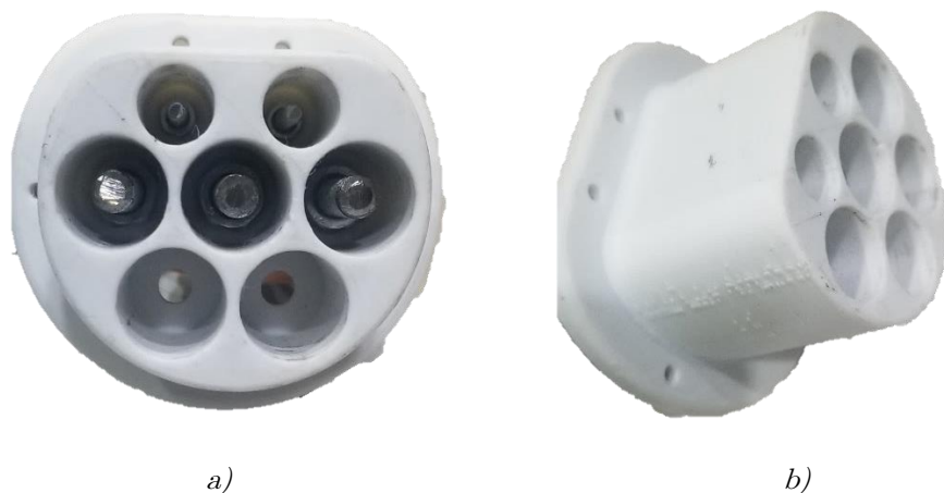
Figura 3.6 Impresión del Conector de Entrada de Vehículo para Modo de Carga 2: a) Vista Frontal, b) Vista de Perfil.
