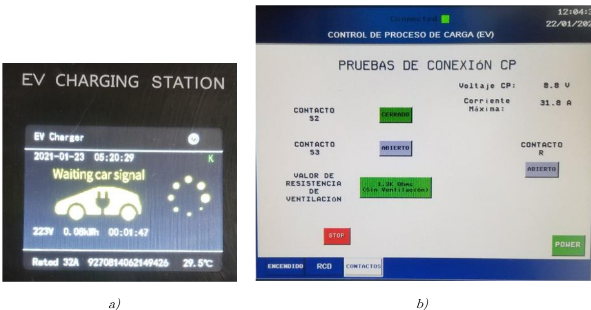
Figura 4.13 Estado E del Proceso de Carga: a) Estación en Espera de Señal de EV, b) Pantalla de CONTACTOS
