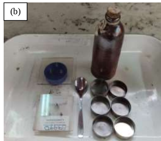
Ilustración 14. Equipo para Límites de Atterberg: (a) Cuchara de Casagrande, (b) Kit para ensayo de Límite de contracción.
