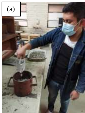
Ilustración 7. Ensayos de peso volumétrico: (a) Procedimiento de llenado del picnómetro por paladas, (b) Procedimiento de varillado para peso volumétrico compactado.
