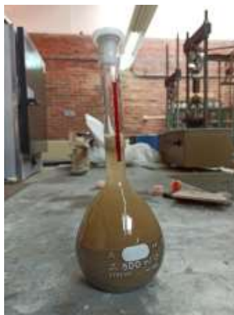
Ilustración 15. Matraz con relave para Densidad Relativa
