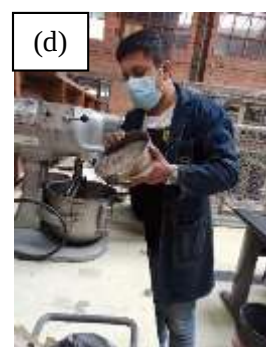
Ilustración 17. Proceso de mezclado en mortero: (a) Lavado de arena, (b) Batidora con agua y aditivo, (c) Incorporación de cemento a la mezcla, (d) Incorporación de arena en velocidad baja, (e) Mezcla de mortero en período de reposo, (f) Mesa de fluidez, (g) Moldes de mortero de 50 mm, agente desmoldante, (h) Orden de apisonado al moldear los especímenes de ensayo. Fuente: (ASTM C109 / C109M, 2016).
