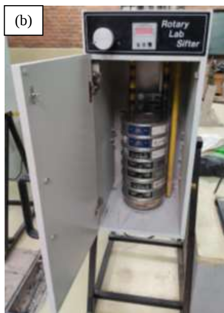
Ilustración 6. Equipo para granulometría por cribado: (a) Para árido grueso, (b) Para árido fino.
