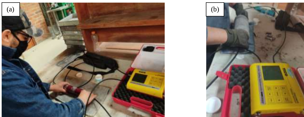
Ilustración 24. Ensayo velocidad de pulso ultrasónico: (a) Calibración, (b) Medición de velocidad
