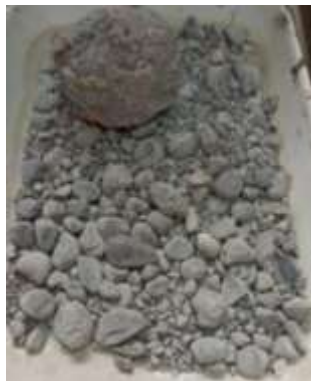
Ilustración 44. Hormigones luego del ensayo de abrasión en condición seca
