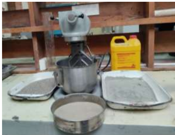
Ilustración 16. Materiales y equipos para elaboración de hormigón
