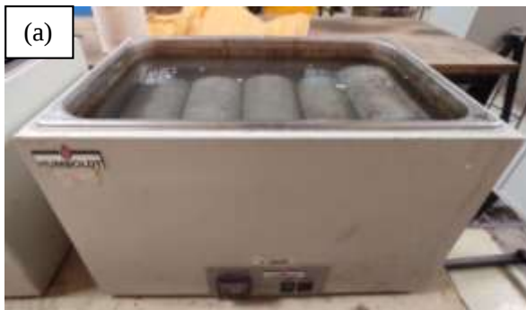
Ilustración 22. Ensayo de absorción y densidad: (a) Ebullición del hormigón a baño María, (b) Canastilla para determinación de masa sumergida.
