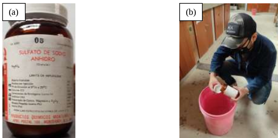
Ilustración 25. Ensayo ataque de sulfato: (a) Compuesto químico de Sulfato de Sodio Anhidro, (b) Incorporación del compuesto
