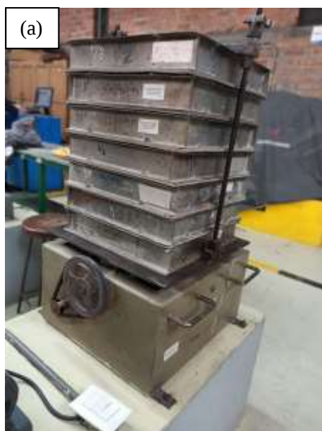
Ilustración 6. Equipo para granulometría por cribado: (a) Para árido grueso, (b) Para árido fino.
