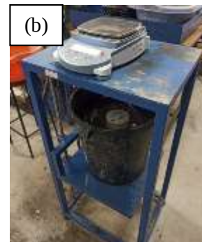
Ilustración 22. Ensayo de absorción y densidad: (a) Ebullición del hormigón a baño María, (b) Canastilla para determinación de masa sumergida.
