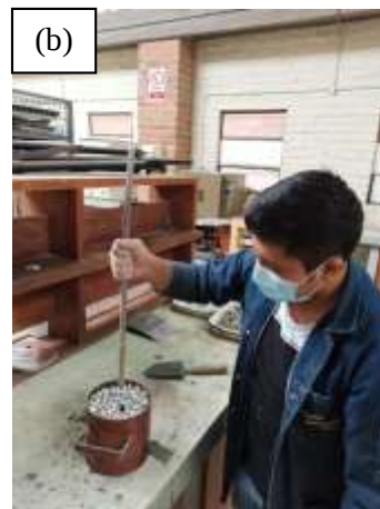
Ilustración 7. Ensayos de peso volumétrico: (a) Procedimiento de llenado del picnómetro por paladas, (b) Procedimiento de varillado para peso volumétrico compactado.
