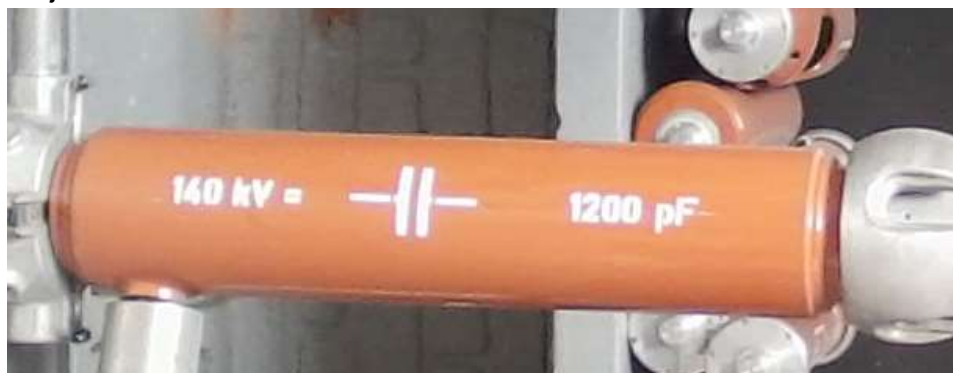
Figura 39 Capacitor para altos voltajes
