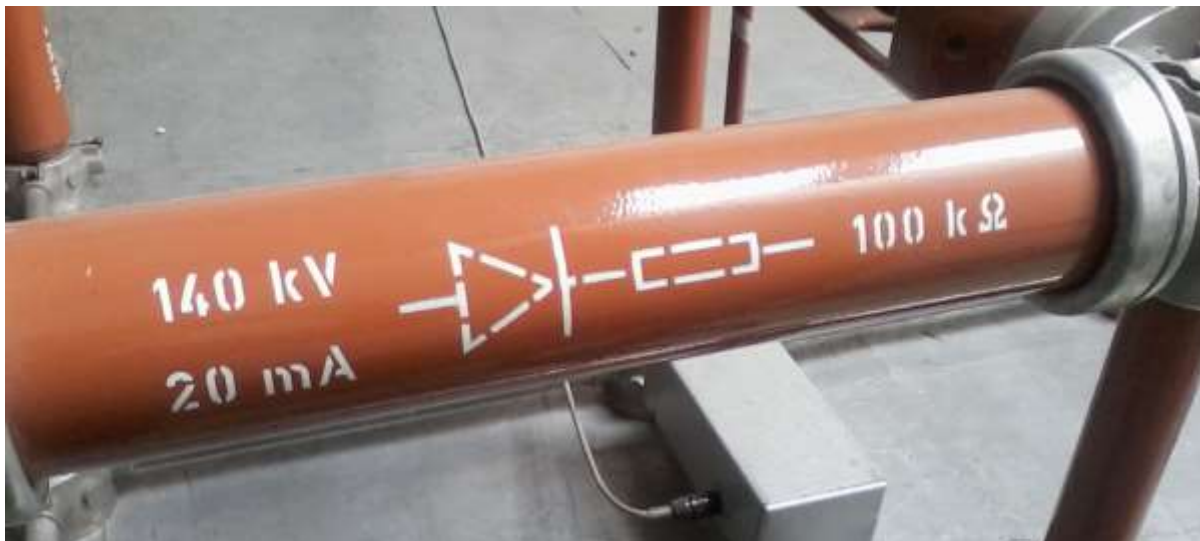
Figura 38 Rectificador de media onda para altos voltajes
