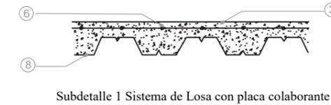
Subdetalle 1 Sistema de Losa con placa colaborante
