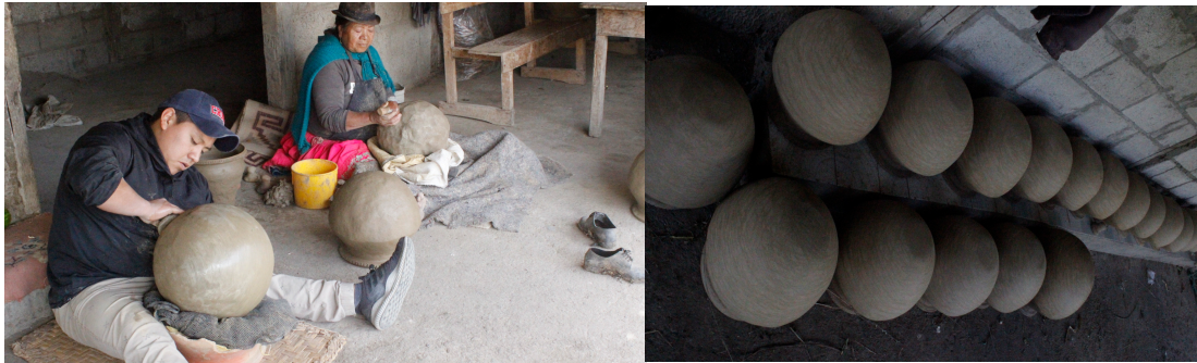
Imagen 79 pulido y secado
