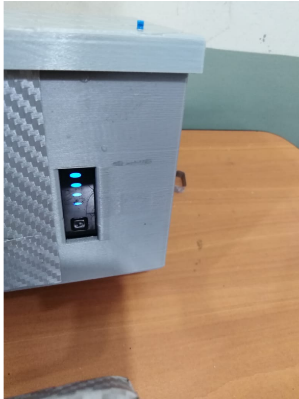
Figura C.6: Apertura para visualizar el estado de almacenamiento del banco la baterías
