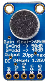
Figura 4.11: Sensor de sonido MAX9814
