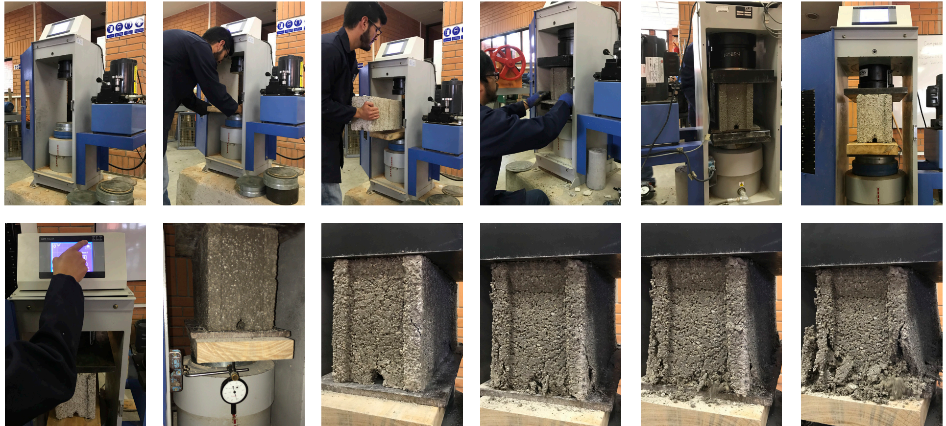
Figura 43.-Proceso del ensayo a compresión en los bloques de concreto (Chiriboga & Quinteros, 2020)
