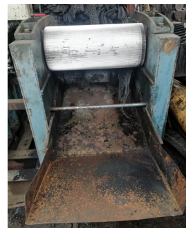
Figura 15.- Falla de la trituradora artesanal por acumulamiento de bandas de caucho en los laterales del rodillo (Chiriboga & Quinteros 2020).
