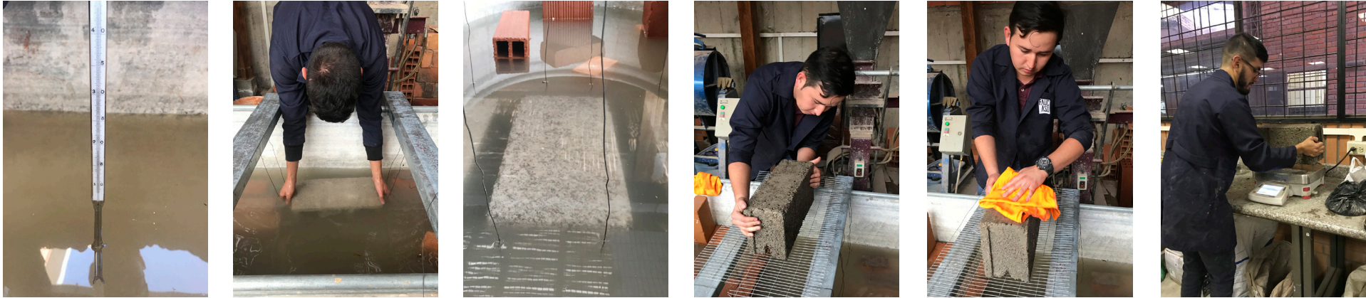
Figura 46.- Proceso del ensayo de absorción en los bloques de concreto (Chiriboga & Quinteros, 2020).
