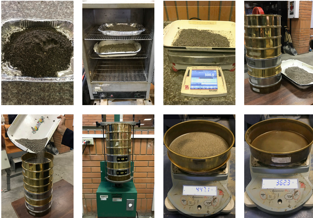
Figura 32.- Proceso del ensayo de granulometría del agregado fino (Chiriboga & Quinteros, 2020).
