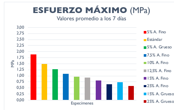
Figura 98.- Diagrama del esfuerzo máximo promedio por tipo de bloque, con valores a los 7 días (Chiriboga & Quinteros, 2020).
