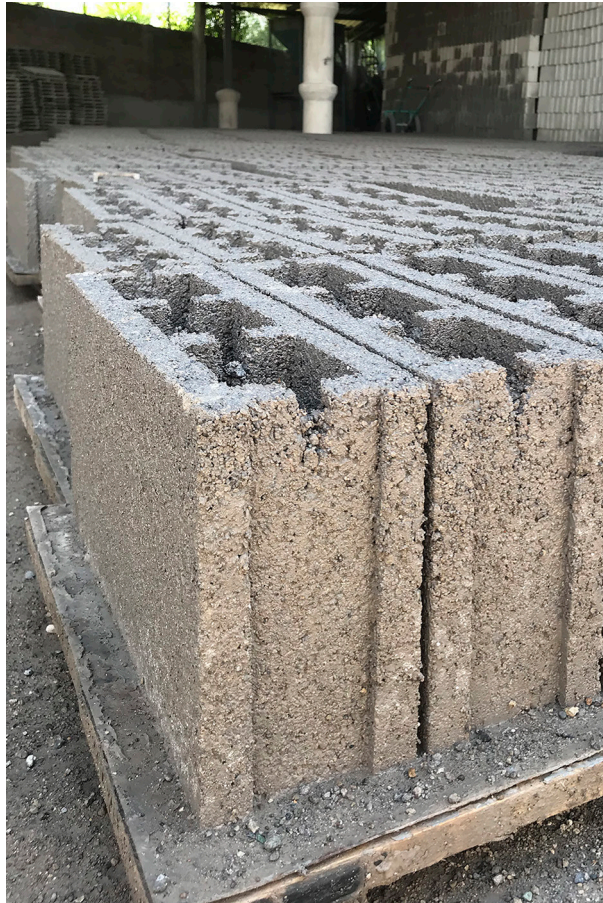
Figura 28.- Fraguado y curado de los bloques de concreto (Chiriboga & Quinteros 2020).
