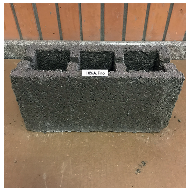
Figura 85.- Espécimen del bloque de concreto con un 10% de reemplazo en el agregado fino (Chiriboga & Quinteros, 2020).
