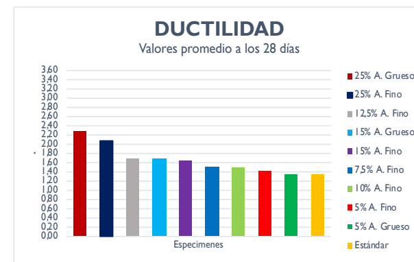
Figura 105.- Diagrama de la ductilidad promedio por tipo de bloque, con valores a los 28 días (Chiriboga & Quinteros, 2020).
