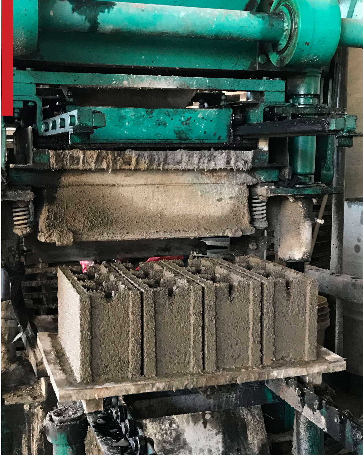
Figura 48.- Bloques de concreto recién elaborados saliendo de la máquina (Chiriboga & Quinteros, 2020).
