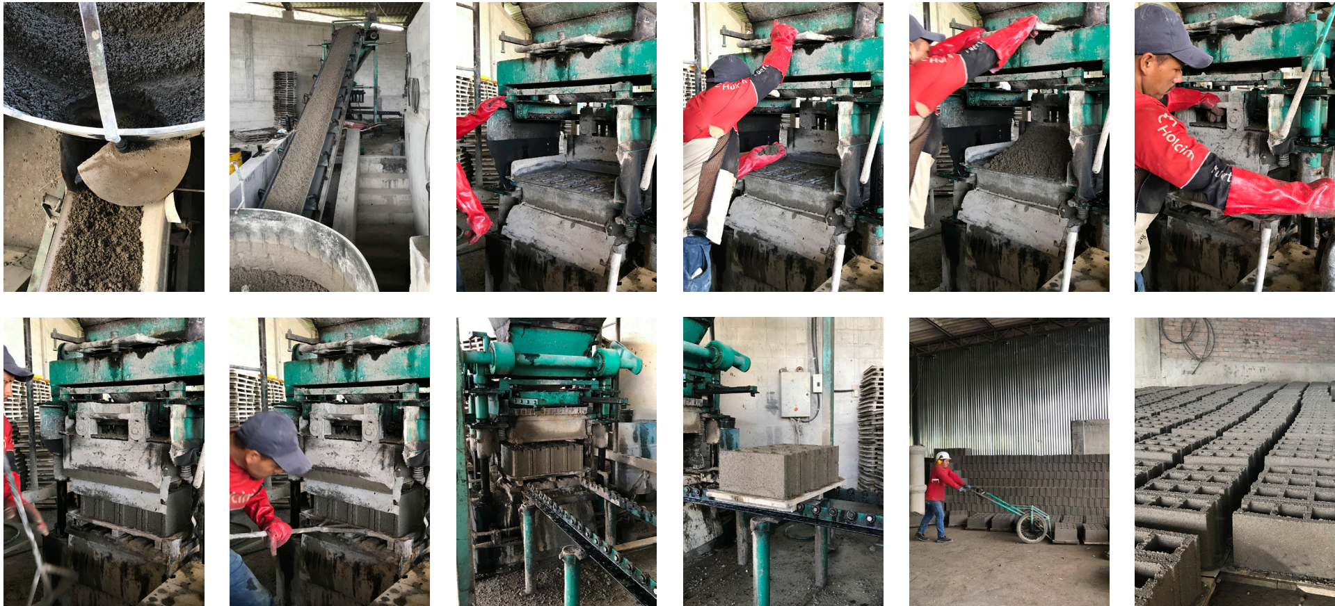
Figura 27.- Proceso de elaboración de los bloques de concreto (Chiriboga & Quinteros, 2020).
