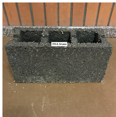
Figura 70.- Espécimen del bloque de concreto con un 15% de reemplazo en el agregado grueso (Chiriboga & Quinteros, 2020).
