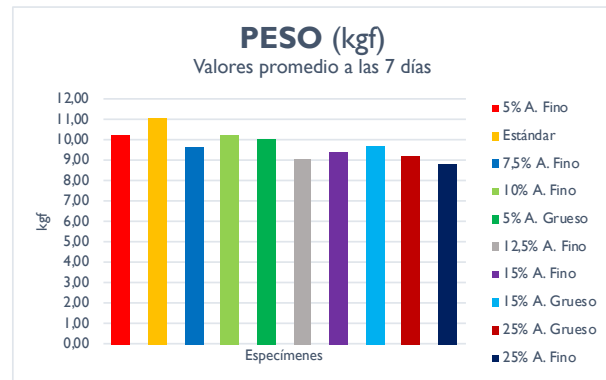
Figura 96.- Diagrama del peso promedio por tipo de bloque, con valores a los 7 días (Chiriboga & Quinteros, 2020).
