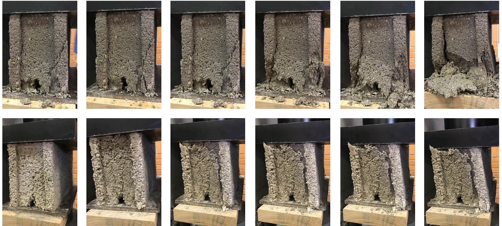
Figura 65.- Proceso de rotura. Parte superior: Bloque estándar. Parte inferior: Bloque de concreto con la inclusión de gránulos de caucho con fibras de acero (Chiriboga & Quinteros, 2020).
