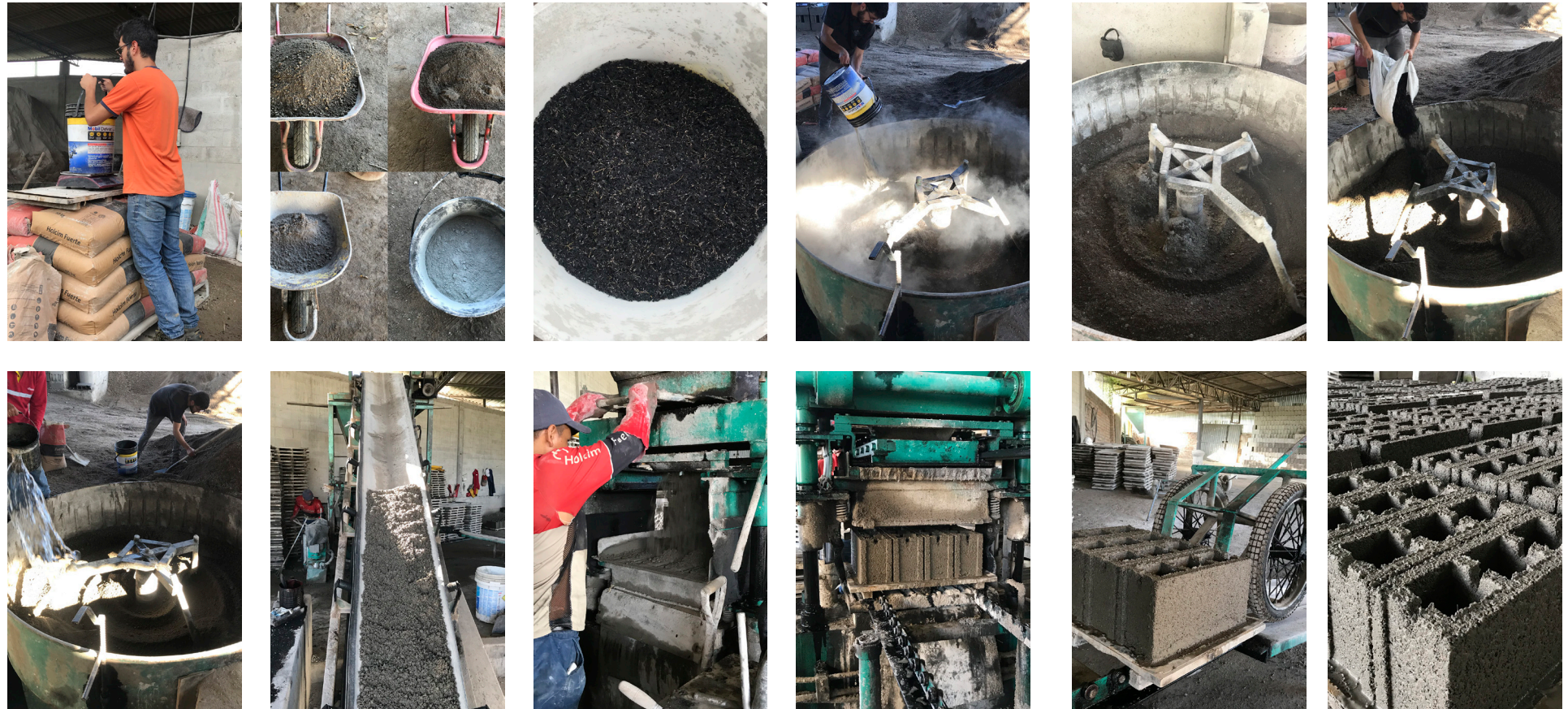
Figura 50.- Proceso de elaboración de los bloques de concreto con inclusión de gránulos de caucho con fibras de acero (Chiriboga & Quinteros, 2020).
