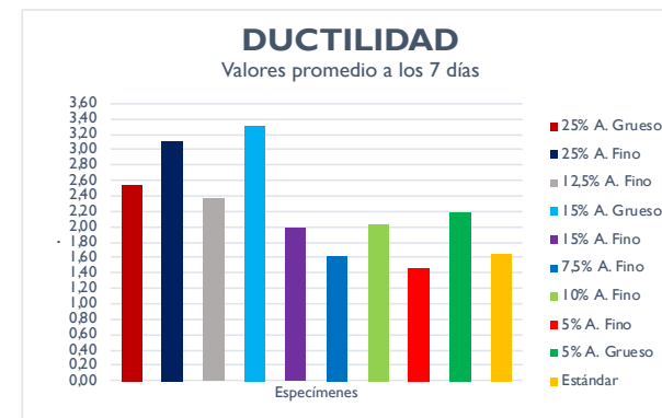
Figura 104.- Diagrama de la ductilidad promedio por tipo de bloque, con valores a los 7 días (Chiriboga & Quinteros, 2020).
