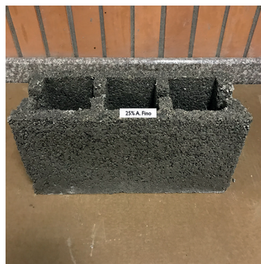
Figura 76.- Espécimen del bloque de concreto con un 25% de reemplazo en el agregado fino (Chiriboga & Quinteros, 2020).
