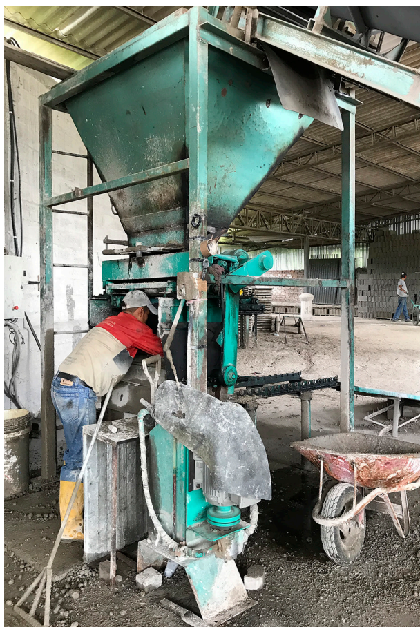
Figura 25.- Operador de la fábrica elaborando los bloques de concreto (Chiriboga & Quinteros 2020).
