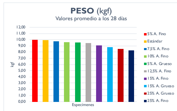
Figura 97.- Diagrama del peso promedio por tipo de bloque, con valores a los 28 días (Chiriboga & Quinteros, 2020).
