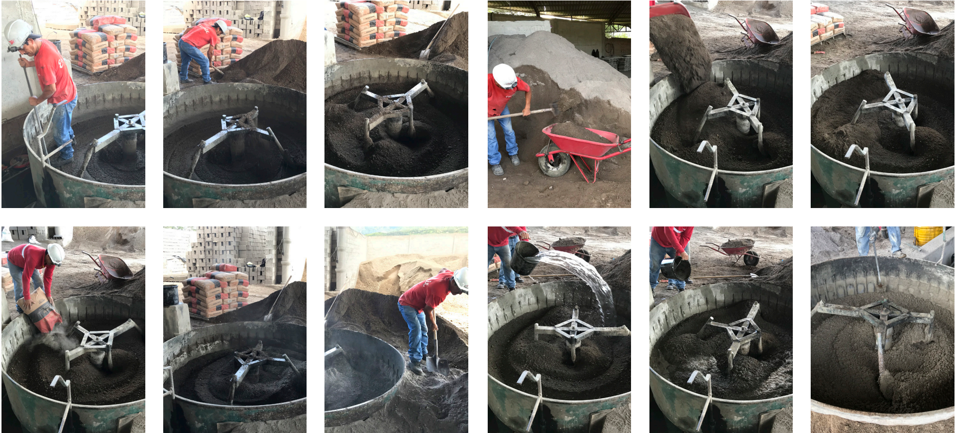
Figura 24.- Proceso de elaboración de la mezcla para los bloques de concreto (Chiriboga & Quinteros 2020).
