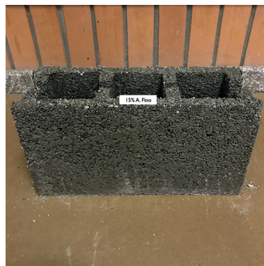
Figura 79.- Espécimen del bloque de concreto con un 15% de reemplazo en el agregado fino (Chiriboga & Quinteros, 2020).
