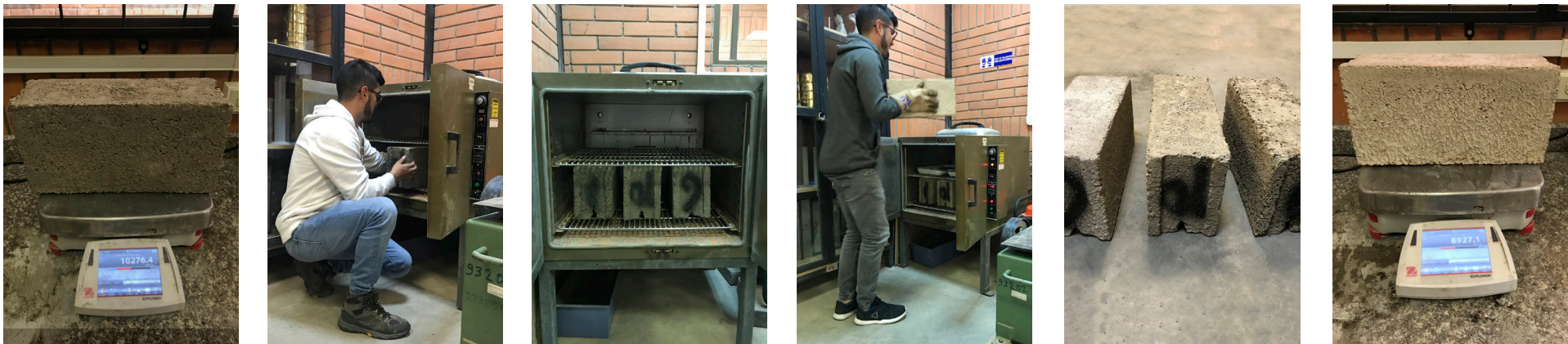
Figura 47.- Proceso del ensayo de humedad en los bloques de concreto (Chiriboga & Quinteros, 2020).
