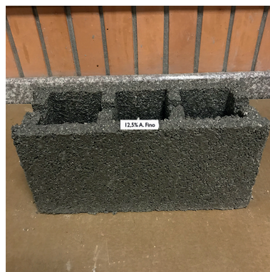
Figura 82.- Espécimen del bloque de concreto con un 12,5% de reemplazo en el agregado fino (Chiriboga & Quinteros, 2020).
