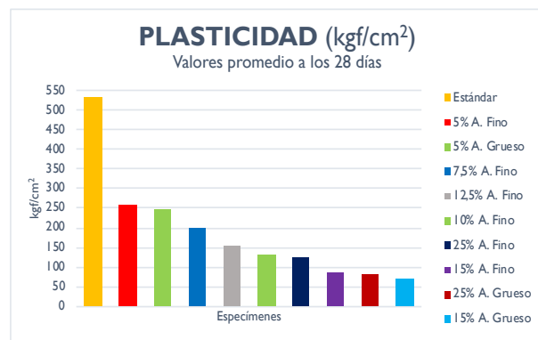
Figura 103.- Diagrama de la plasticidad promedio por tipo de bloque, con valores a los 28 días (Chiriboga & Quinteros, 2020).
