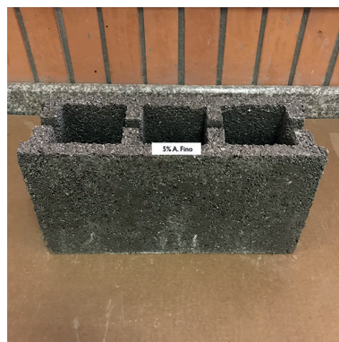
Figura 91.- Espécimen del bloque de concreto con un 5% de reemplazo en el agregado fino (Chiriboga & Quinteros, 2020).
