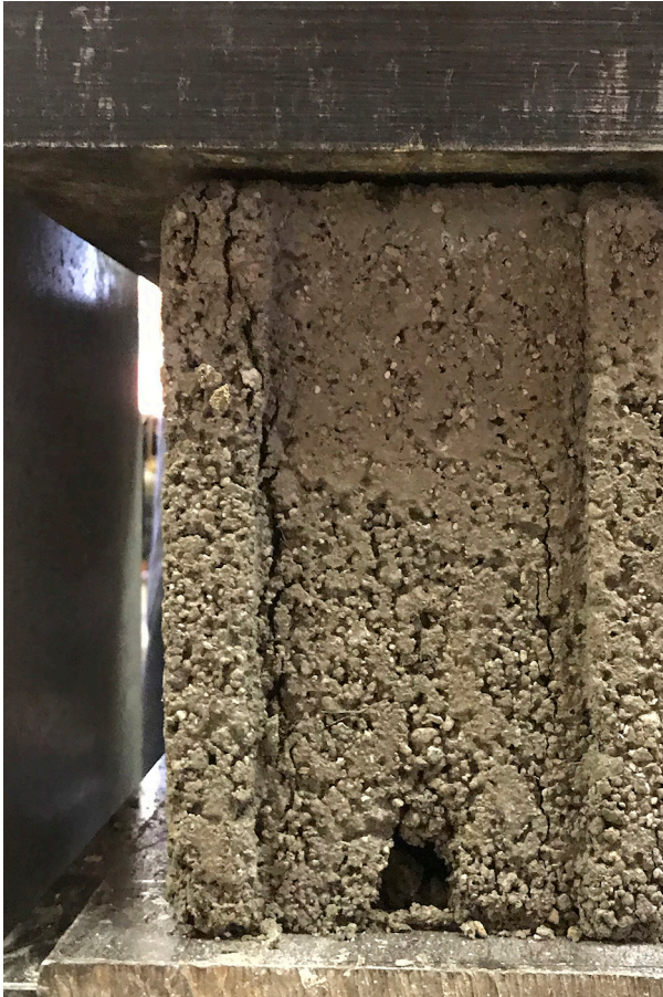
Figura 42.- Bloque de concreto durante el ensayo a compresión simple (Chiriboga & Quinteros 2020).
