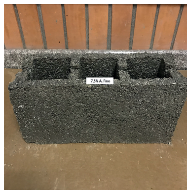
Figura 88.- Espécimen del bloque de concreto con un 7,5% de reemplazo en el agregado fino. (Chiriboga & Quinteros, 2020).
