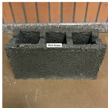
Figura 73.- Espécimen del bloque de concreto con un 5% de reemplazo en el agregado grueso (Chiriboga & Quinteros, 2020).
