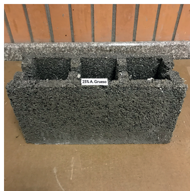
Figura 67.- Espécimen del bloque de concreto con un 25% de reemplazo en el agregado grueso (Chiriboga & Quinteros, 2020).
