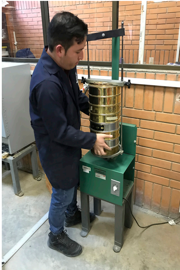
Figura 31.- Colocación de los tamices en el agitador mecánico (Chiriboga & Quinteros 2020).
