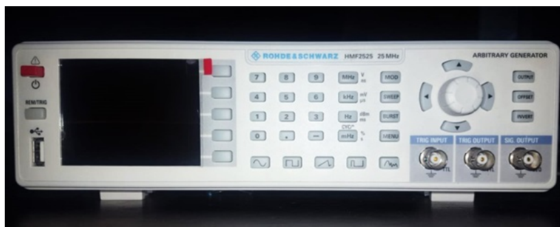
Figura 5.7: Generador de funciones marca ROHDE&SCHWARZ modelo HMF2525
