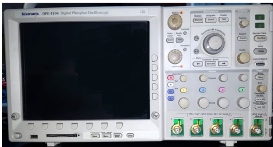
Figura 5.5: Osciloscopio digital marca tektronix modelo DPO4104
