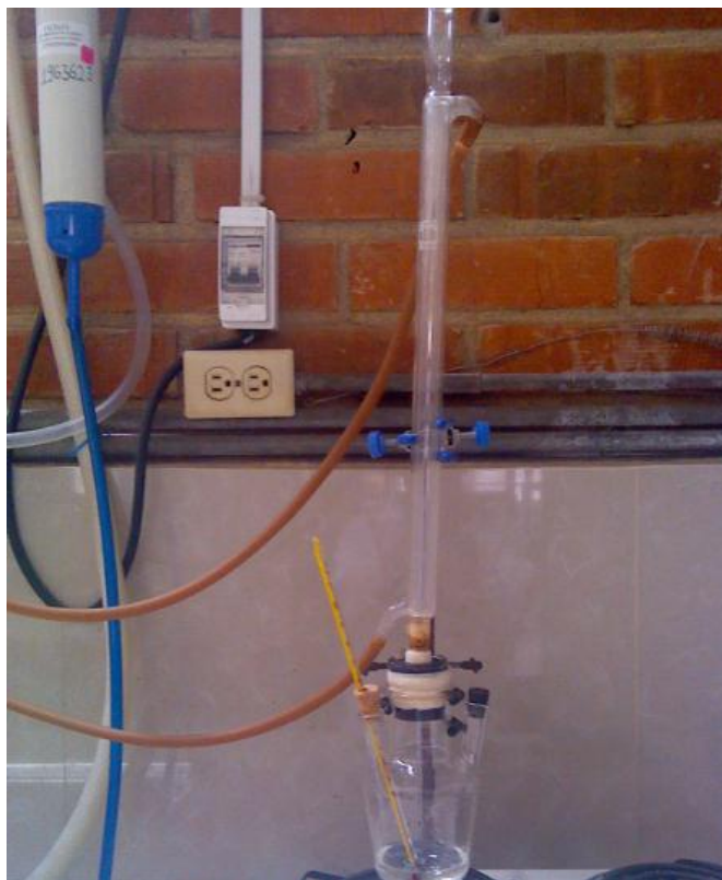
Ilustración 24. Montaje del equipo de medición de la temperatura de ebullición.
