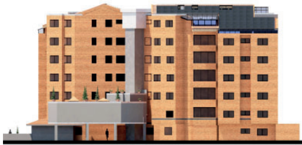
Imagen 4.15: Elevación lateral derecha con paneles sin contactos metálicos distribuidos en techumbre Fuente: Elaboración autores.
