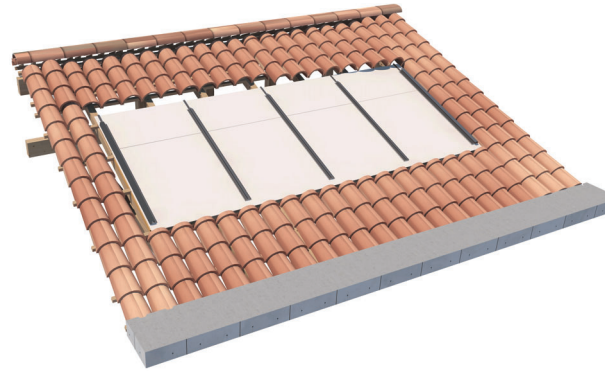
Imagen 4.20: Colocación de perfiles de aluminio Fuente: Elaboración autores.
