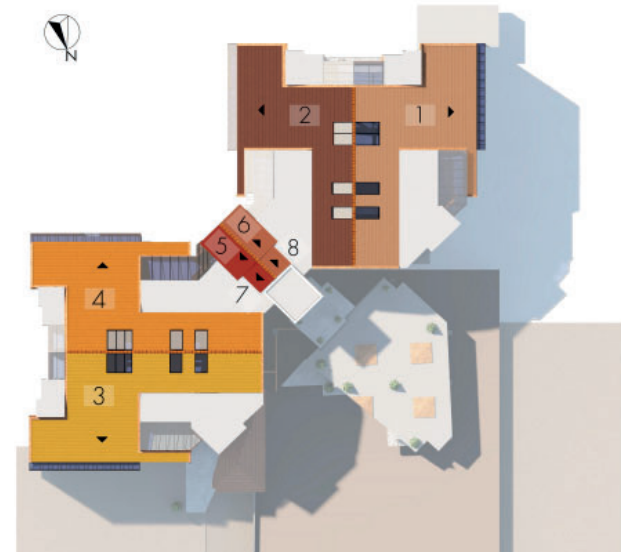
Imagen 4.01: Clasificación de faldones según ángulo Azimut Fuente: Elaboración autores.
