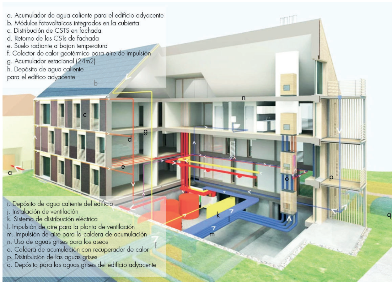
Imagen 2.39: Esquema de ingeniería Kraftwerk B Fuente: Reina, 2014.
