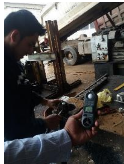
Fotografía 14 Medición iluminación Fotografía 13 Medición iluminación Fotografía 12 Medición de iluminación
