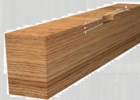
Medición de agujero y/o nudo suelto en la arista.
