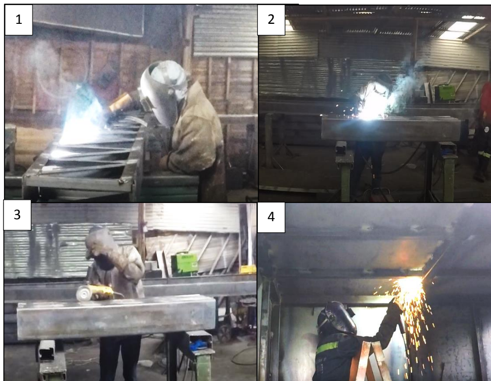
Fotografía 3. Actividades Soldador: 1. Soldadura de Cerchas 2. Soldadura de Columnas o Vigas 3. Limpieza de escoria en soldadura 4. Soldadura de casetas para cajeros. Elaboración: Autor.
