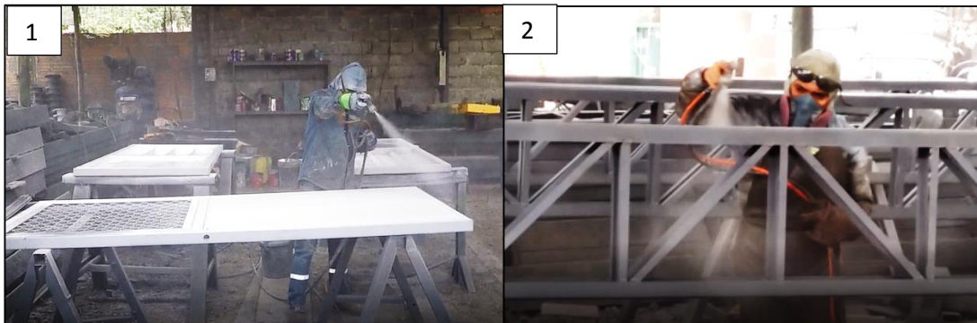
Aplicación de Pintura Anticorrosiva en cerchas. Elaboración: Autor.
