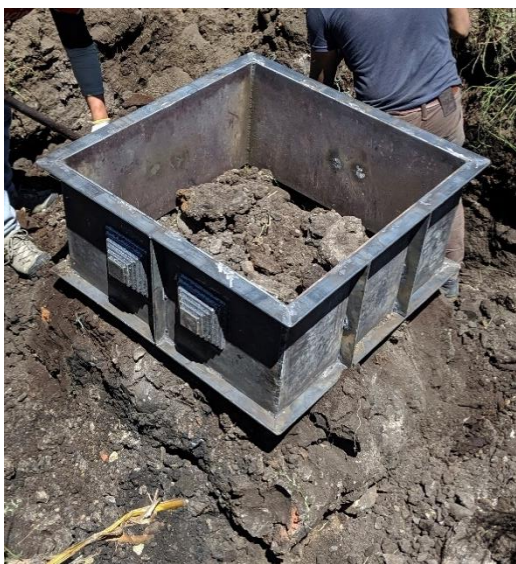
Figura 34. Colocación de caja de corte sobre dado de suelo.
