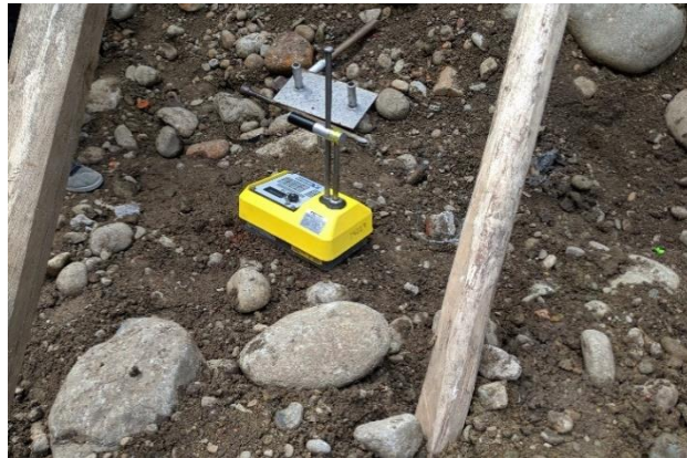
Figura 14. Determinación de densidad mediante densímetro nuclear.
