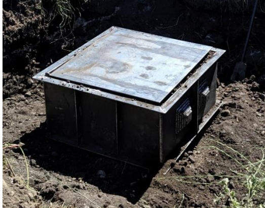
Figura 29. Placa utilizada para distribuir esfuerzos normales. Figura 30. Cemento utilizado para producir esfuerzo normal.
