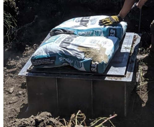
Figura 29. Placa utilizada para distribuir esfuerzos normales. Figura 30. Cemento utilizado para producir esfuerzo normal.
