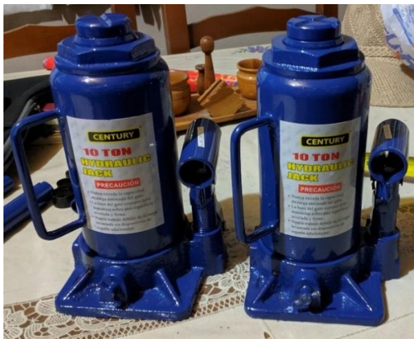
Figura 26. Gatos hidráulicos antes de la modificación.
