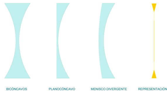
FIGURA 5: Molina, Nataly (2015) Tipos de lentes divergentes (ilustración)
