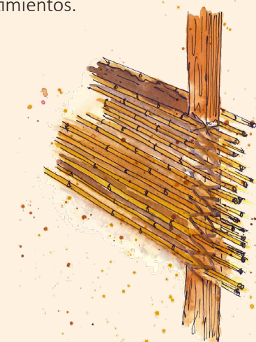
Fig. 139: Armadura auxiliar, enchagaleado. Elaboración: Propia.
