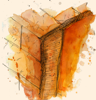
Fig. 142: Empañete. Elaboración: Propia.
