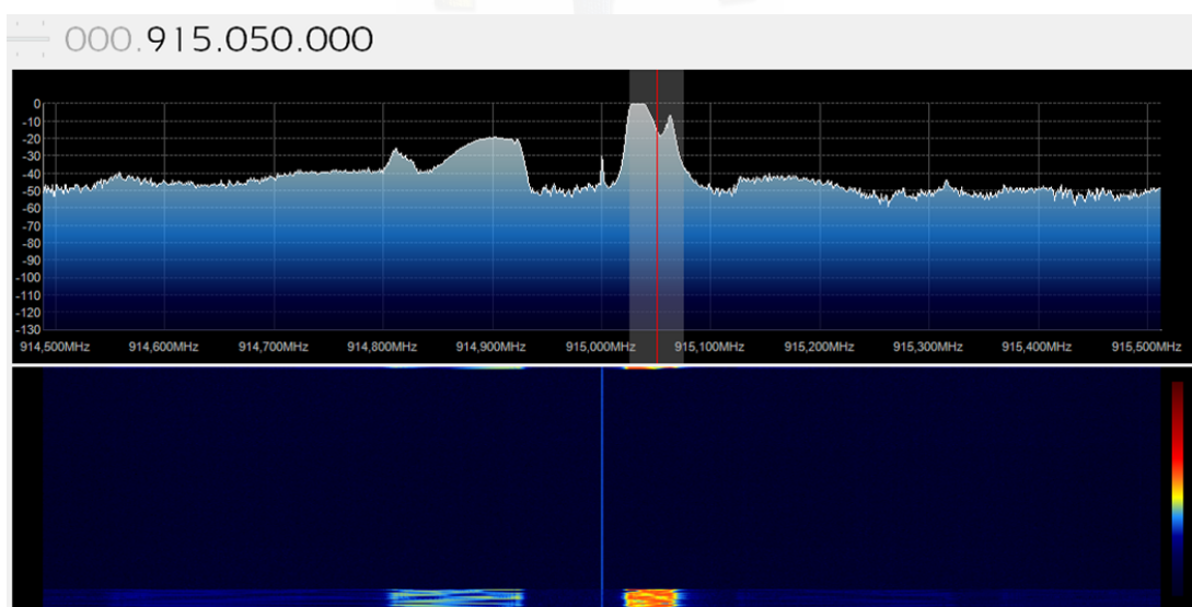
Figura C.1: Señal capturada por el SDR con SF=7 Y BW=41.7KHz
