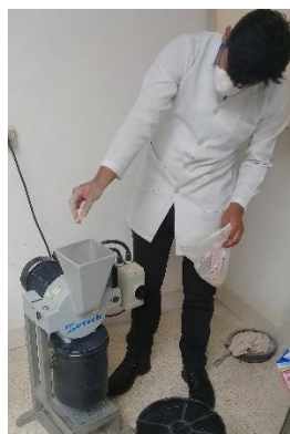
Figura No. 3 Proceso de molido del Bagazo de Caña de azúcar
