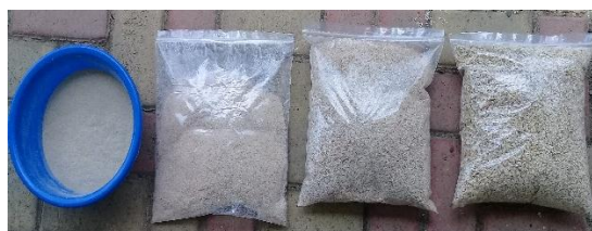
Figura No. 4 Proceso de Tamizado y Clasificación de partículas de Bagazo de Caña
