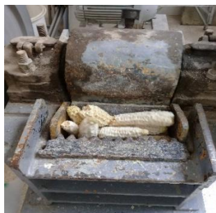
Figura No. 5 Proceso de molienda de la Coronta de maíz
