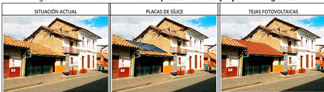
Figura 6. Caso Modelo 0202-05 con placas de sílice y tejas PV integradas
