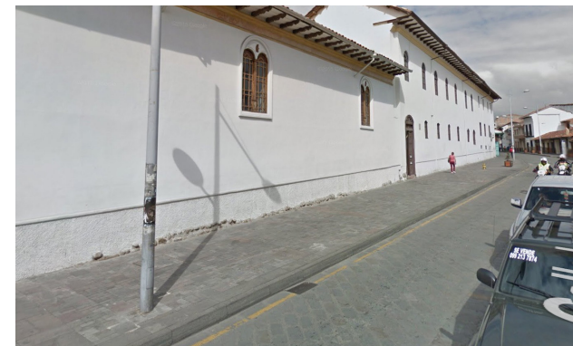
Fig 108. Acera sin buffer de seguridad. Cortesía Google, 2015.
