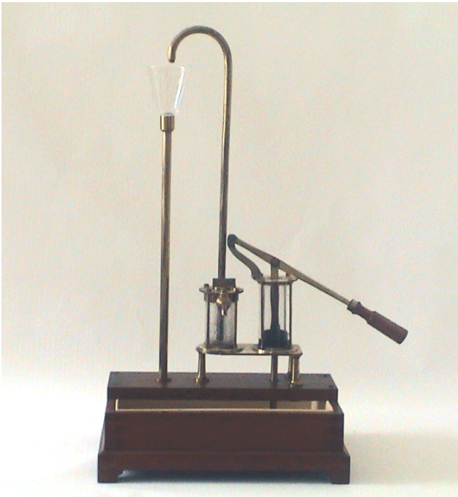
Fig. 017: Réplica de una bomba mixta utilizada para elevar líquidos a una altura máxima de 10 metros.
