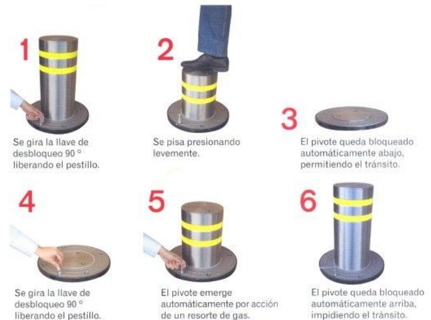
Figura 4.38: Esquema de bolardos retráctiles semiautomáticos.
