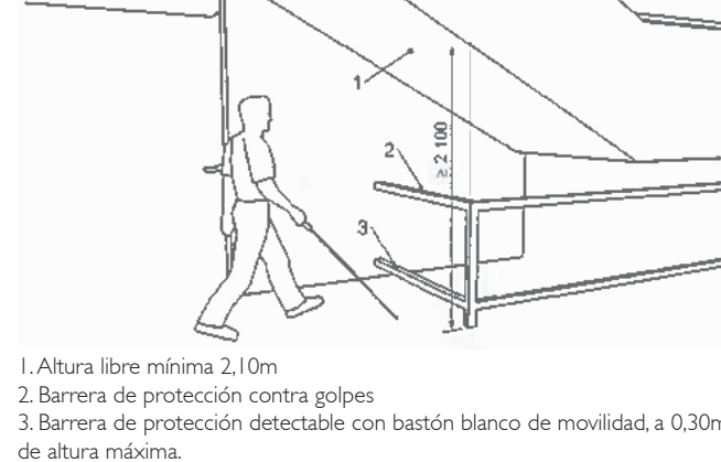
Imagen 15: Altura libre de la escalera Fuente: NTE INEN-ISO 21542
