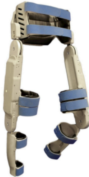
Figura 1.4: Exoesqueleto Vanderbilt (2012), diseñado para asistencia en la caminata de personas con paraplegia. [14]
