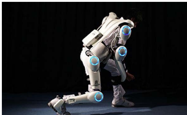
Figura 1.1: Exoesqueleto HAL de cuerpo completo. [11]
