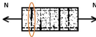
Figura 17. Fisuras por tracción simple en un elemento, aplicando fuerza axial.
