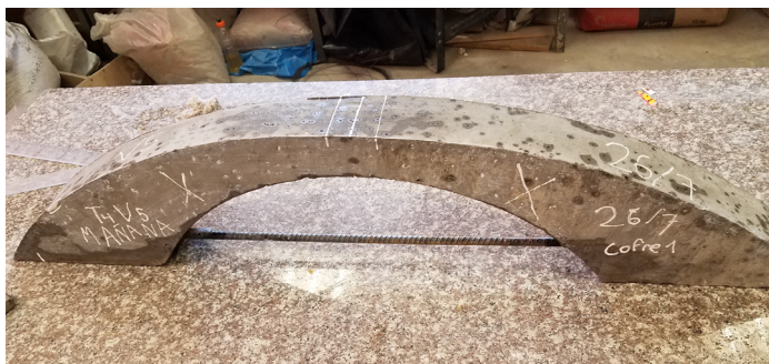
Figura 108: Viga tipo C antes del ensayo a compresión. Fuente propia.
