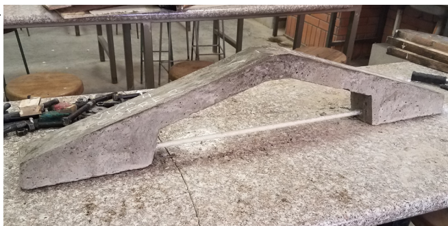
Figura 104: Viga tipo B antes del ensayo a compresión Fuente propia.
