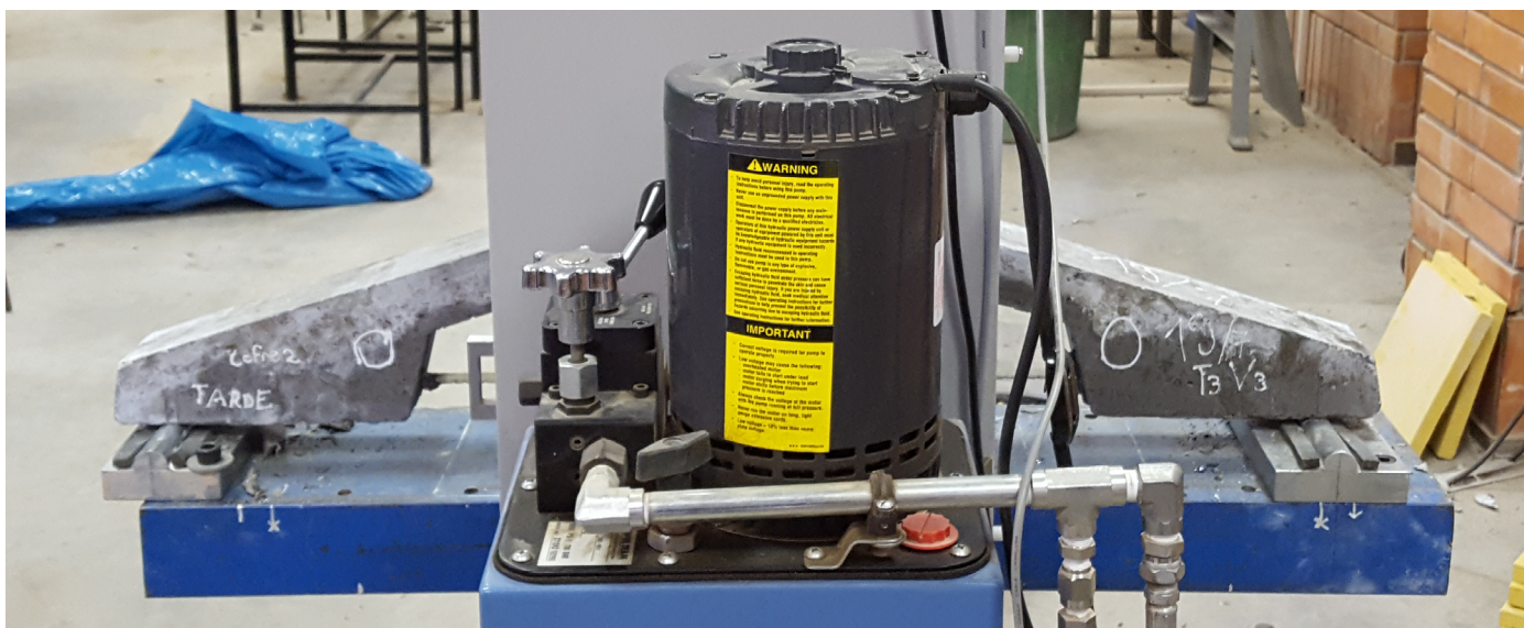
Figura 105: Viga tipo B durante el proceso del ensayo. Fuente propia.
