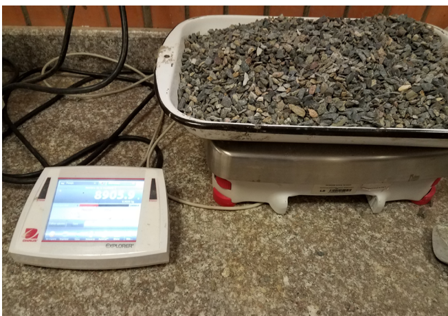
Figura 124: Pesado del agregado grueso para la fundición del hormigón. (Fuente propia)
