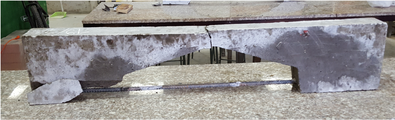
Figura 112: Viga tipo D luego de ser ensayada. Fuente propia.
