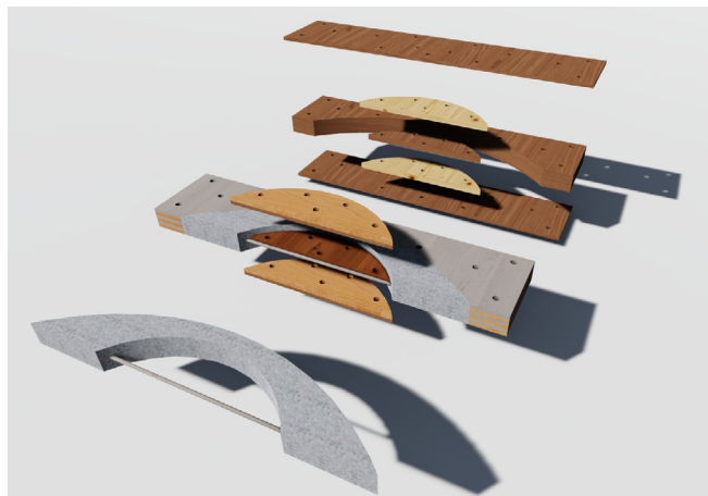
Figura 116: Representación 3d del armado de cofre de la viga tipo D. (Fuente propia).
