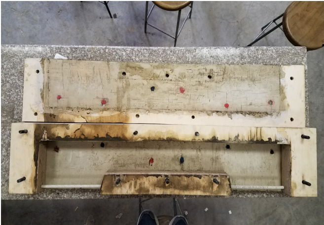
Figura 118: Encofrado de la viga tipo A. (Fuente propia)
