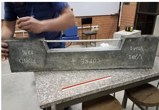
Figura 127: Medición de la viga tipo A antes de ser ensayada. (Fuente propia)
