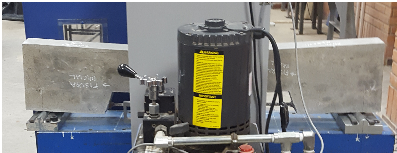
Figura 101: Viga tipo A durante el proceso del ensayo. Fuente propia.
