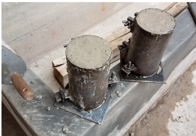
Figura 126: Probetas cilíndricas para ensayos de hormigón elaboradas en cada fundición. (Fuente propia)
