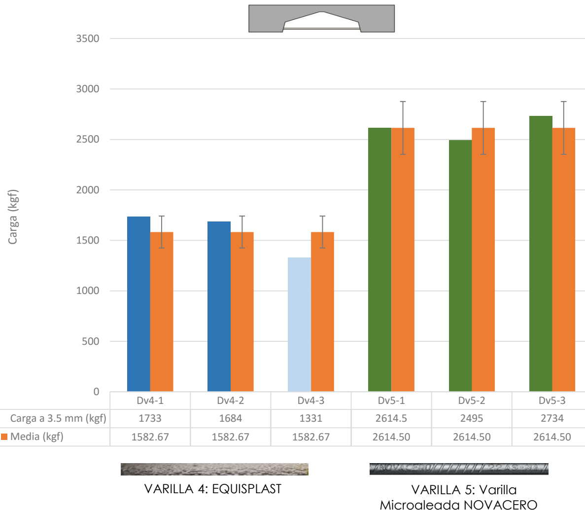
Figura 150 Carga 3.5 mm de deformación en viga Tipo D. Fuente propia.
