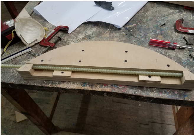
Figura 120: Parte extraíble del encofrado de la viga tipo D. (Fuente propia)
