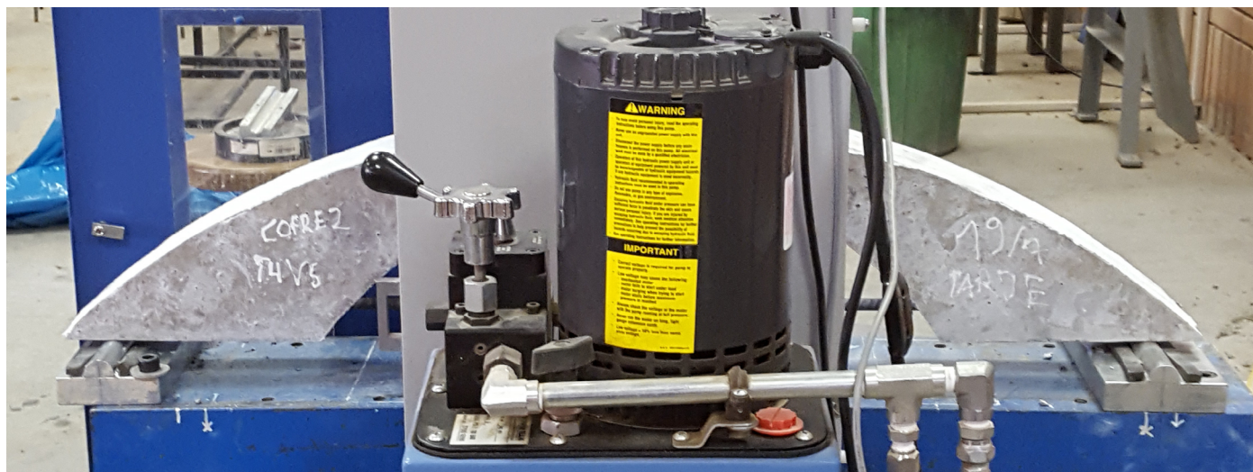
Figura 109: Viga tipo C durante el proceso del ensayo. Fuente propia
