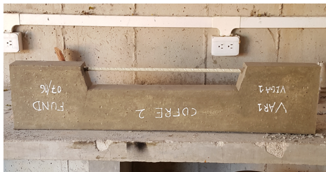
Figura 100: Viga tipo A luego de 24 horas de fundido el hormigón. Fuente propia.
