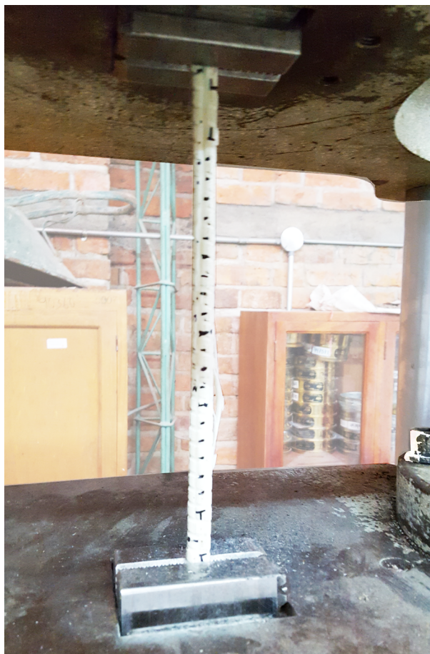
Figura 73: Varilla ComBar de \varnothing 9 mm luego de la rotura. Fuente propia
