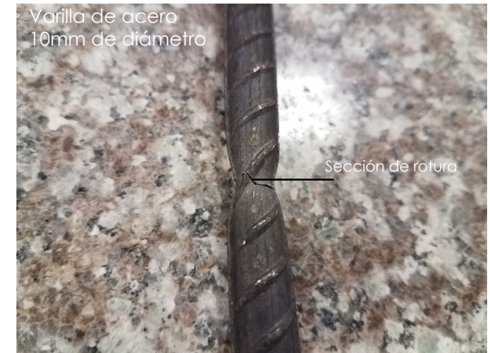
Figura 81: Varilla de acero luego del ensayo a tracción. Fuente propia
