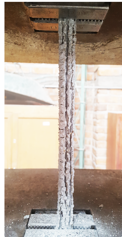
Figura 77: Varilla Equisplast de \varnothing 12 mm luego de la rotura. Fuente propia
