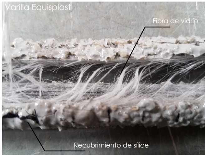
Figura 79: Varilla Equisplast luego del ensayo a tracción. Fuente propia
