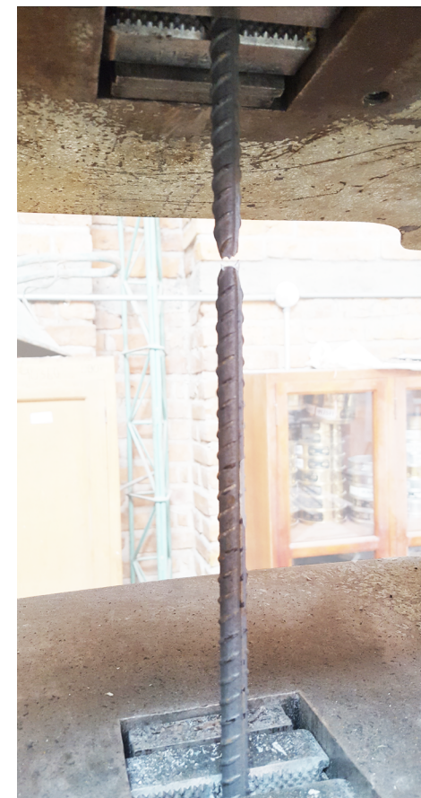
Figura 61: Varilla de acero de \Phi 12 mm luego de la rotura. Fuente propia
