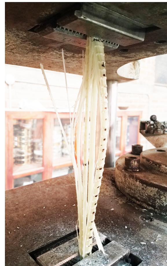
Figura 69: Varilla Marshall C-Bar \varnothing 10mm luego de la rotura. Fuente propia
