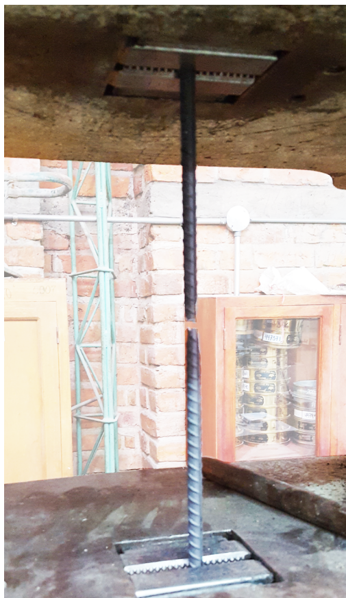
Figura 57: Varilla de acero de \phi 10 mm luego de la rotura. Fuente propia
