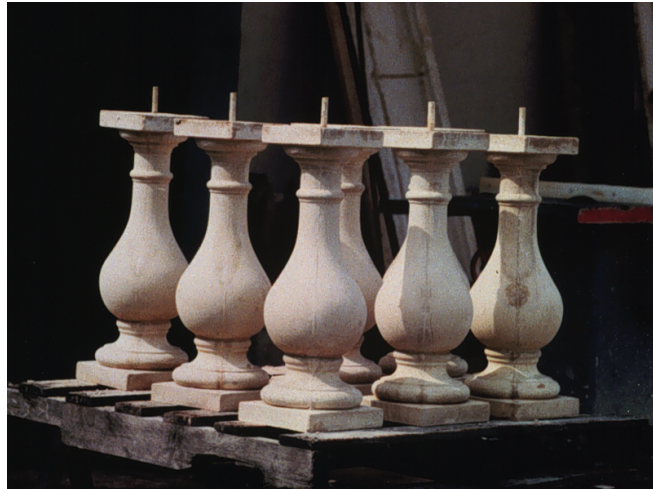
Figura 20: Ejemplo de hormigón ornamental prefabricado con varillas de GFRP Aslan 100 (Tomada de Hughes Brothers, 2017).
