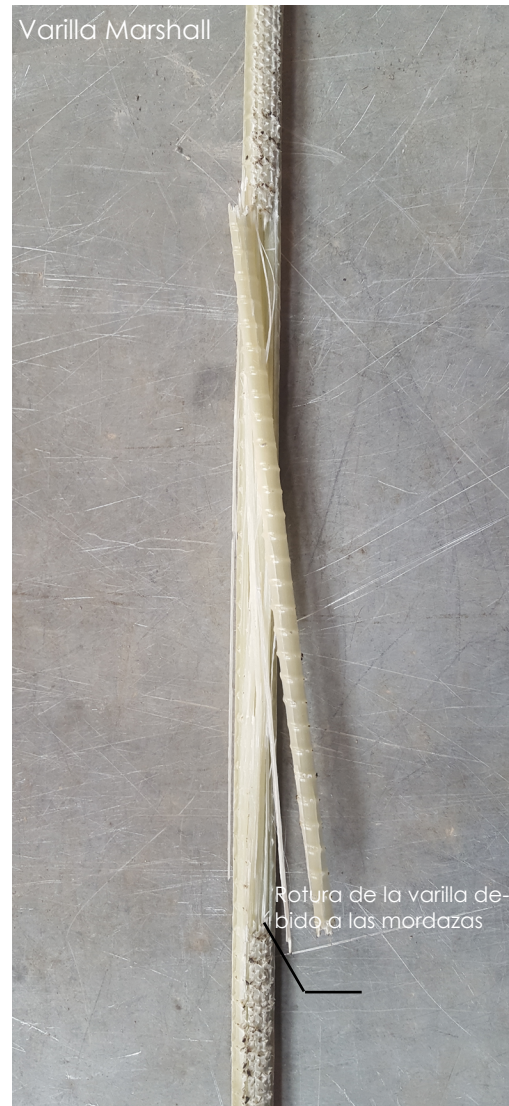
Figura 86: Aplastamiento de los extremos de la varilla Marshall. Fuente propia
