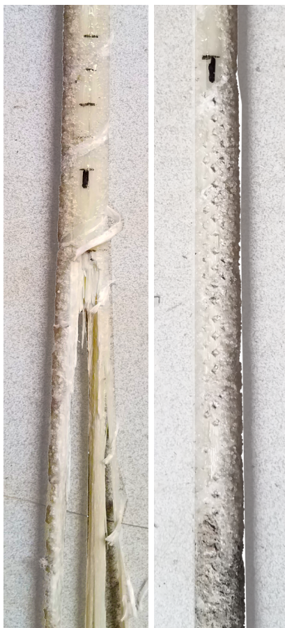
Figura 65: Varilla Aslan 100 de \varnothing 10 mm luego de la rotura. Fuente propia
