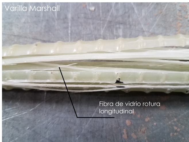
Figura 82: Varilla Marshall luego del ensayo a tracción. Fuente propia
