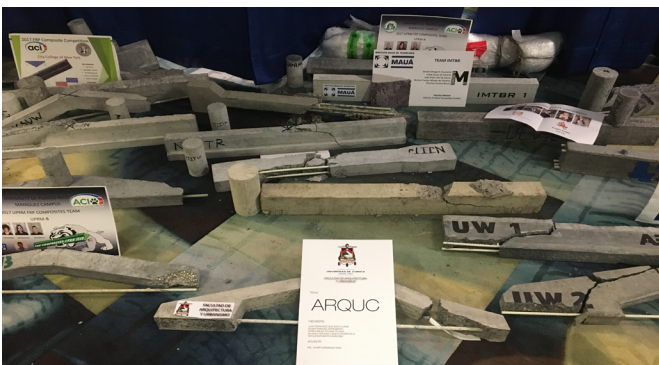
Figura 32: Vigas ensayadas en el concurso FRP 2017, Detroit, MI. Fuente propia.
