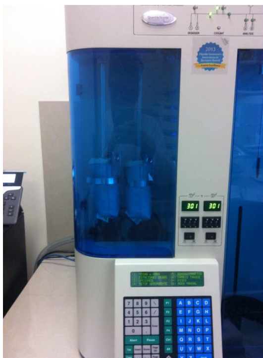
Ilustración 2-4: Desgasificación de la muestra de catalizador en la estación de Degas del equipo BET.
