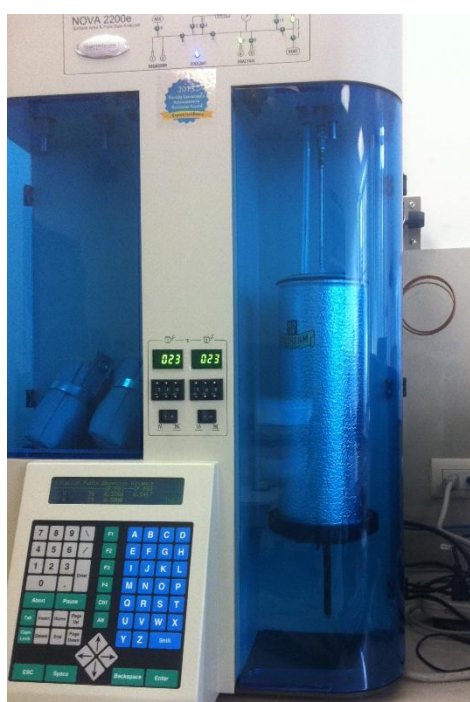
Ilustración 2-6: Fisisorción con N_2 líquido de la muestra de catalizador en la estación de adsorción
