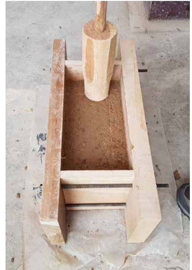
Imagen c44: Sarmiento, I. & Cárdenas, A (2017). Compactación en muestras pequeñas tipo 4. [Fotografía]. Cuenca, Ecuador.
