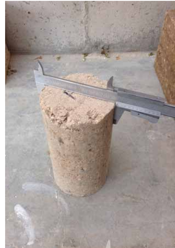
Imagen c74: Sarmiento, I. & Cárdenas, A (2017). Muestras tipo 5 en cilindro ASTM. [Fotografía]. Cuenca, Ecuador.
