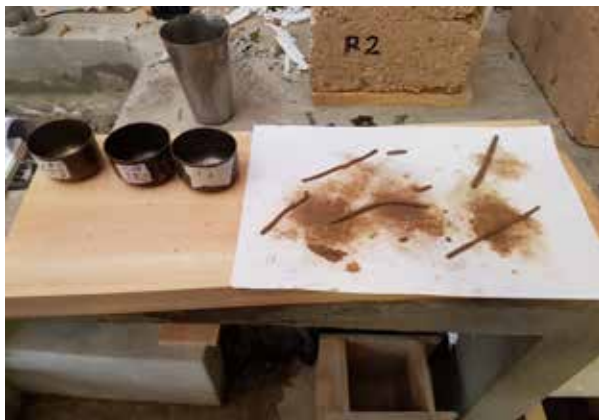
Imagen b37: Sarmiento, I. & Cárdenas, A (2017). Ensayo de límite plástico. Equipos y materiales [Fotografía]. Cuenca, Ecuador.
