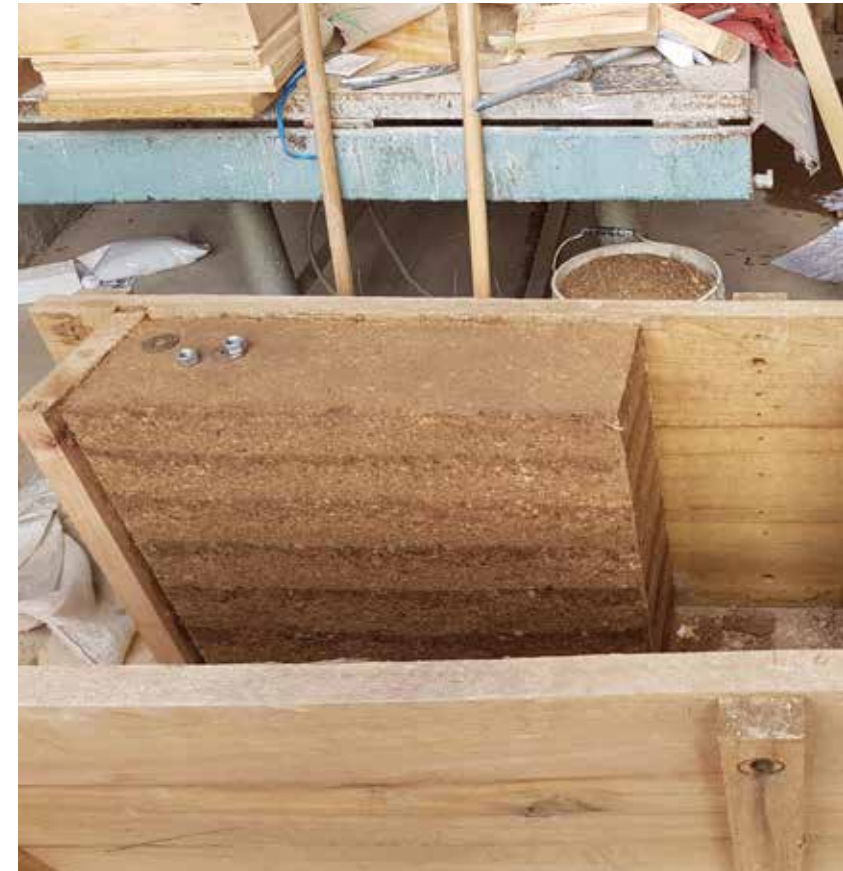
Imagen c80: Sarmiento, I. & Cárdenas, A (2017). Desencofrado de muestras tipo 7 muretes de 20x60x52cm. [Fotografía]. Cuenca, Ecuador.
