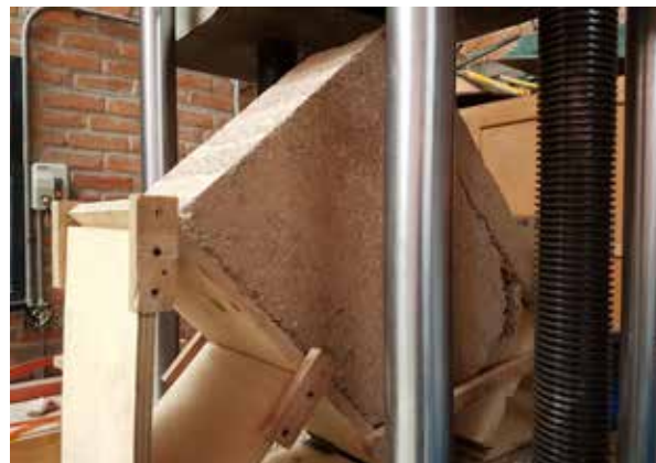
Imagen c81: Sarmiento, I. & Cárdenas, A (2017). Prueba de tracción diagonal en muestras tipo 7 murete de 20x60x52cm. [Fotografía]. Cuenca, Ecuador.
