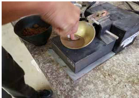
Imagen b33: Sarmiento, I. & Cárdenas, A (2017). Ensayo de límite líquido. Materiales y equipos [Fotografía]. Cuenca, Ecuador.
