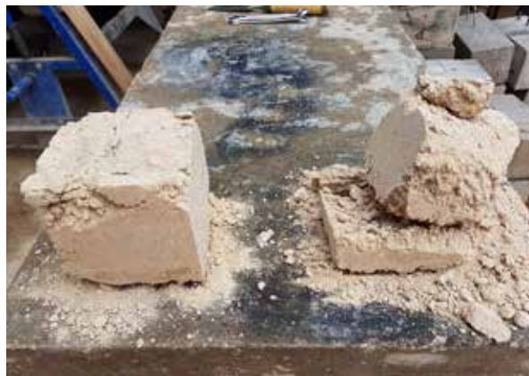
Imagen c56: Sarmiento, I. & Cárdenas, A (2017). Desencofrado de muestras tipo 2 de 10x10x10cm. [Fotografía]. Cuenca, Ecuador.
