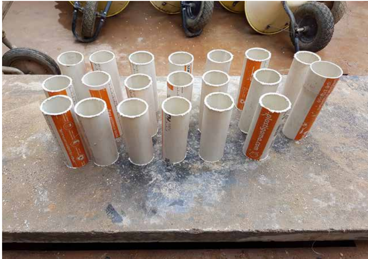
Imagen c40: Sarmiento, I. & Cárdenas, A (2017). Policloruro de vinilo cortado para las muestras . [Fotografía]. Cuenca, Ecuador.
