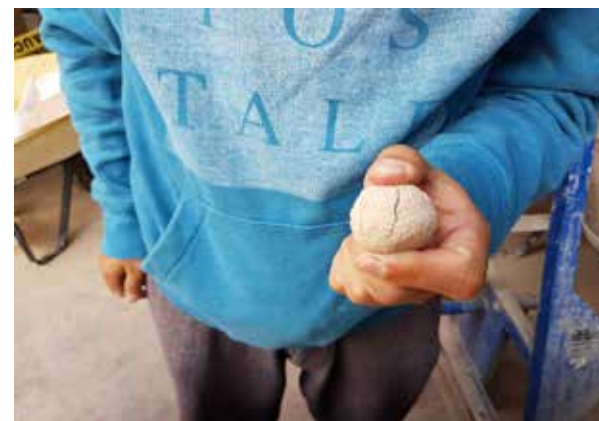
Imagen b18: Sarmiento, I. & Cárdenas, A (2017). Ensayo de la pastilla [Fotografía]. Cuenca, Ecuador.
