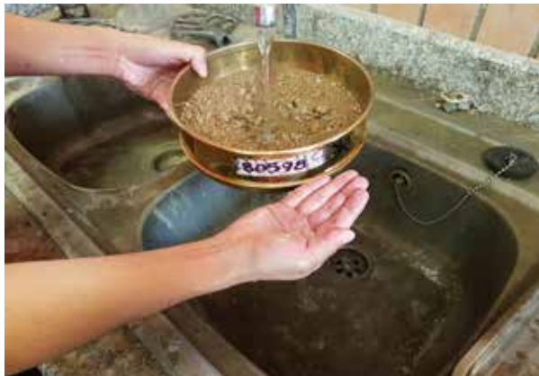
Imagen b26: Sarmiento, I. & Cárdenas, A (2017). Ensayo de lavado de la tierra [Fotografía]. Cuenca, Ecuador.
