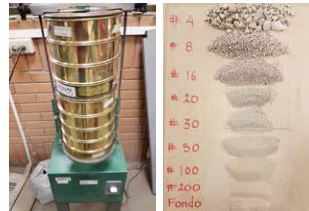
Imagen b28: Sarmiento, I. & Cárdenas, A (2017). Ensayo de granulometría [Fotografía]. Cuenca, Ecuador.
