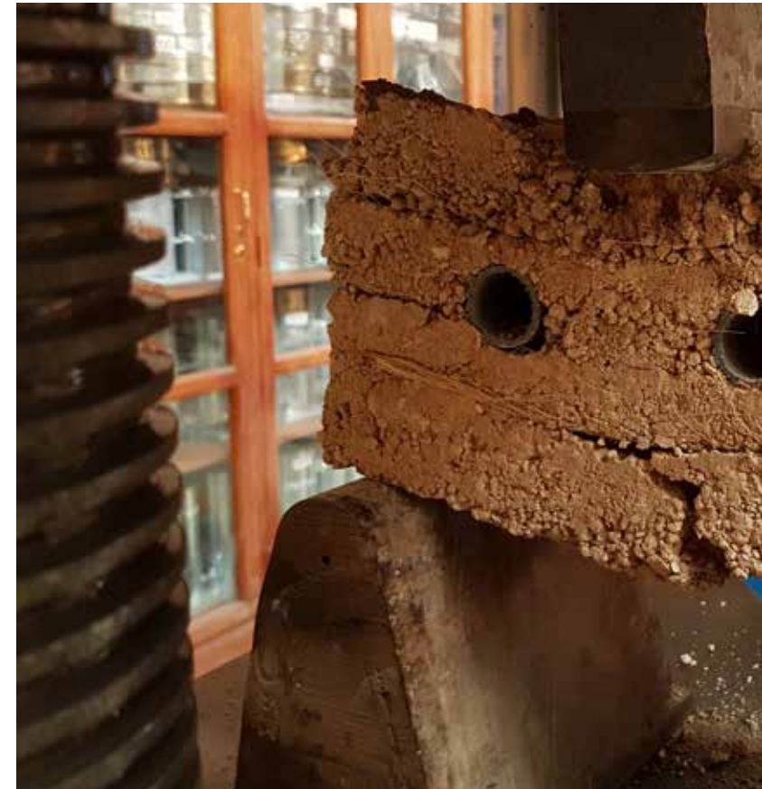
Imagen d17: Sarmiento, I. & Cárdenas, A (2017). Prueba de resistencia a la flexión muestra tipo IV modelo I [Fotografía]. Cuenca, Ecuador.
