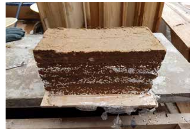
Imagen c67: Sarmiento, I. & Cárdenas, A (2017). Muestras tipo 4 con espuma flex de 15x30x15cm . [Fotografía]. Cuenca, Ecuador.
