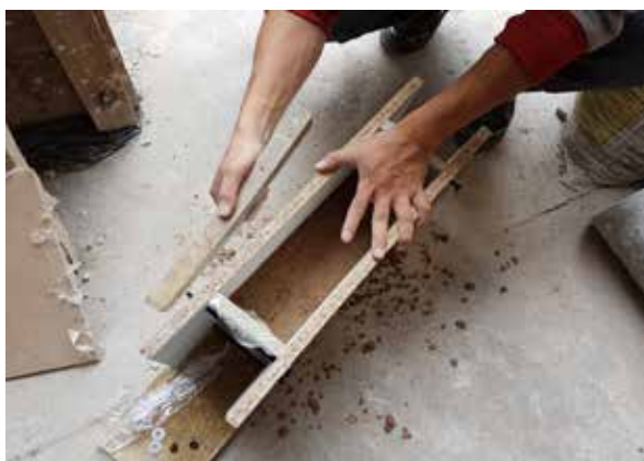
Imagen c60: Sarmiento, I. & Cárdenas, A (2017). Fabricación de muestras tipo 3 de 10x30x15cm. [Fotografía]. Cuenca, Ecuador.
