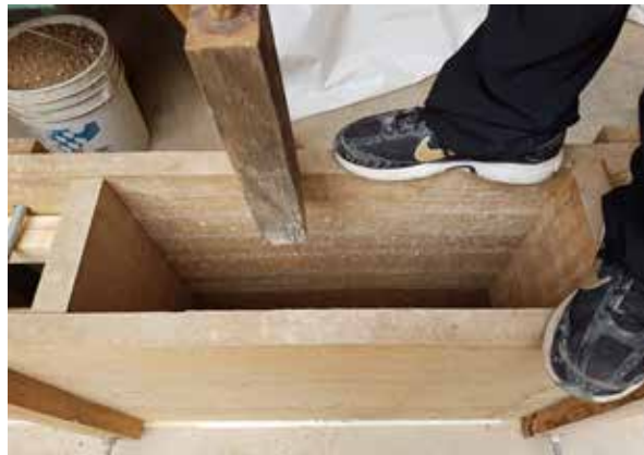
Imagen c78: Sarmiento, I. & Cárdenas, A (2017). Desencofrado de muestras tipo 7 muretes de 20x60x52cm. [Fotografía]. Cuenca, Ecuador.
