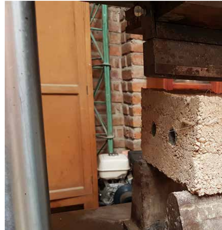
Imagen d14: Sarmiento, I. & Cárdenas, A (2017). Ensayo de muestras tipo IV modelo I a flexión. [Fotografía]. Cuenca, Ecuador.
