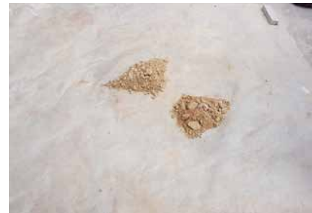
Imagen b24: Sarmiento, I. & Cárdenas, A (2017). Ensayo de cuarteo de la muestra [Fotografía]. Cuenca, Ecuador.
