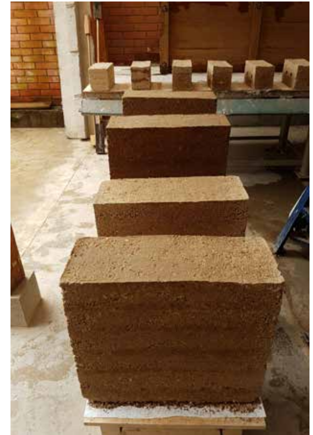
Imagen c77: Sarmiento, I. & Cárdenas, A (2017). Muestras tipo 6 muretes de 20x60x60cm. [Fotografía]. Cuenca, Ecuador.
