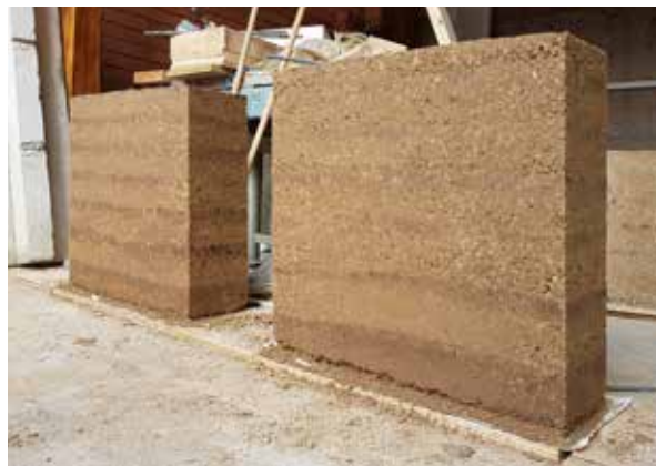
Imagen c75: Sarmiento, I. & Cárdenas, A (2017). Fabricación de muestras tipo 6 muretes de 20x60x60cm. [Fotografía]. Cuenca, Ecuador.
