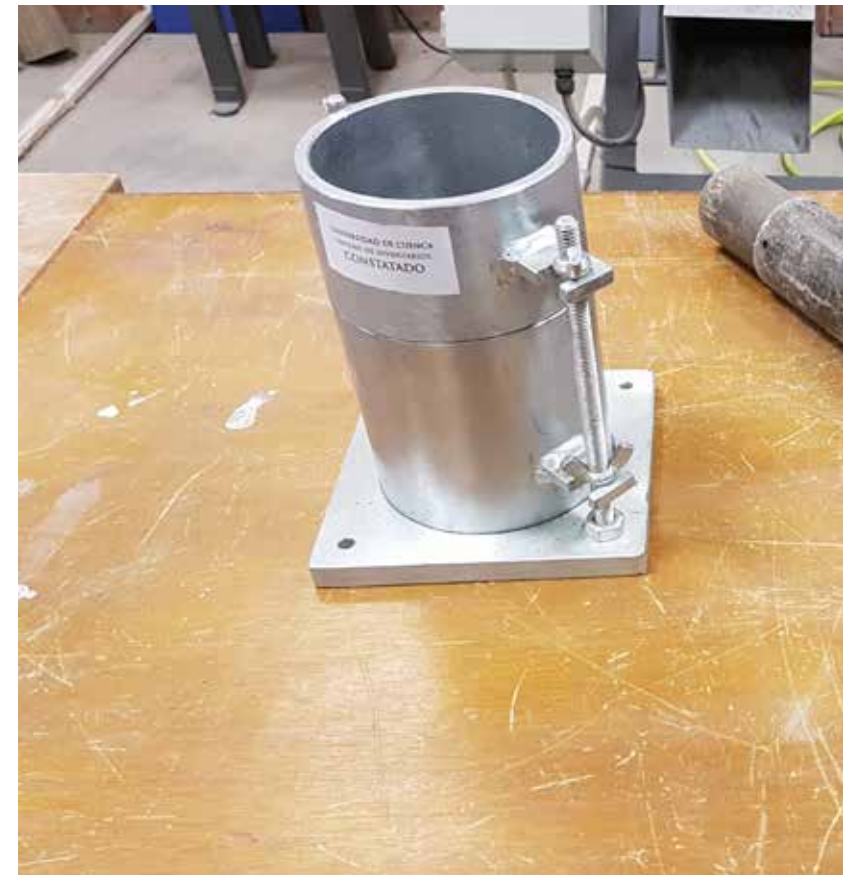
Imagen b44: Sarmiento, I. & Cárdenas, A (2017). Ensayo de proctor estándar. Equipos y materiales [Fotografía]. Cuenca, Ecuador.
