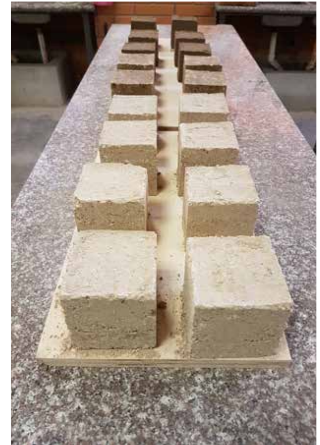
Imagen d6: Sarmiento, I. & Cárdenas, A (2017). Muestras tipo II fabricadas con un porcentaje de humedad diferente. [Fotografía]. Cuenca, Ecuador.
