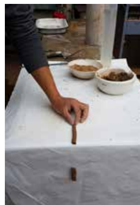
Imagen b14 b15: Sarmiento, I. & Cárdenas, A (2017). Ensayo de la cinta [Fotografía]. Cuenca, Ecuador.
