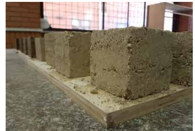
Imagen c58: Sarmiento, I. & Cárdenas, A (2017). Muestras tipo 2 de 10x10x10cm con alto contenido de humedad. [Fotografía]. Cuenca, Ecuador.
