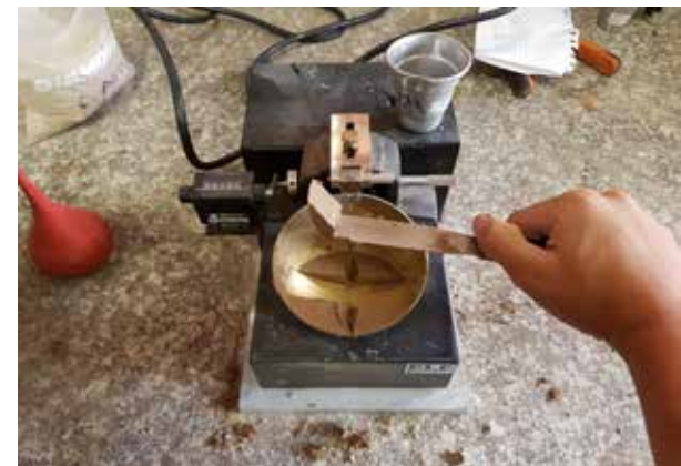
Imagen b35: Sarmiento, I. & Cárdenas, A (2017). Ensayo de límite líquido. División previa a la toma de muestra [Fotografía]. Cuenca, Ecuador.
