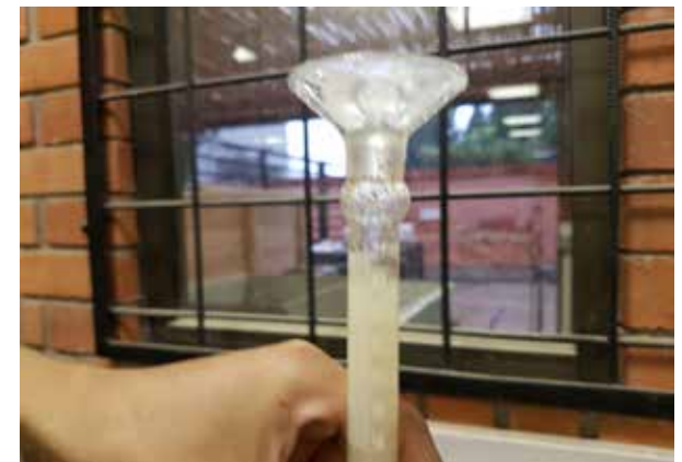
Imagen b42: Sarmiento, I. & Cárdenas, A (2017). Ensayo de densidad. Picnómetro colocado en equipo de baño maria [Fotografía]. Cuenca, Ecuador.
