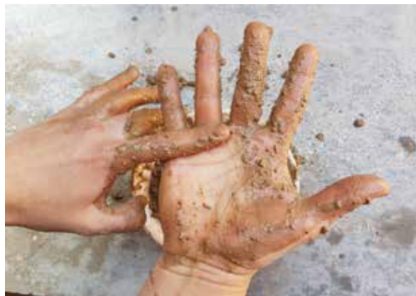
Imagen b20: Sarmiento, I. & Cárdenas, A (2017). Ensayo lavado de manos [Fotografía]. Cuenca, Ecuador.
