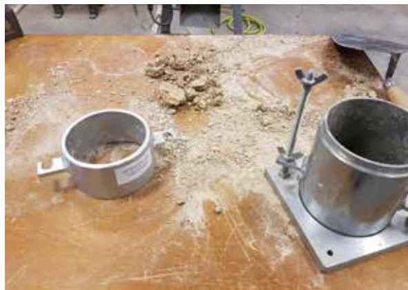
Imagen b45: Sarmiento, I. & Cárdenas, A (2017). Ensayo de proctor estándar. Compactación del material mediante 25 golpes [Fotografía]. Cuenca, Ecuador.
