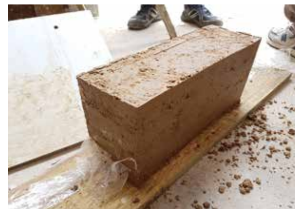
Imagen c62 y c63: Sarmiento, I. & Cárdenas, A (2017). Desencofrado de muestras tipo 3 de 10x30x15cm. [Fotografía]. Cuenca, Ecuador.
