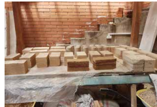
Imagen c70: Sarmiento, I. & Cárdenas, A (2017). Muestras tipo 4 cabuya mas PVC de 15x30x15cm . [Fotografía]. Cuenca, Ecuador.
