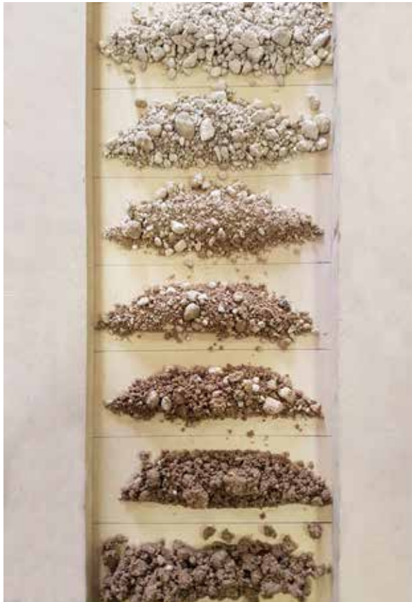
Imagen d3: Sarmiento, I. & Cárdenas, A (2017). Tierra con diferente porcentaje de humedad para la fabricación de muestras tipo II. [Fotografía]. Cuenca, Ecuador.
