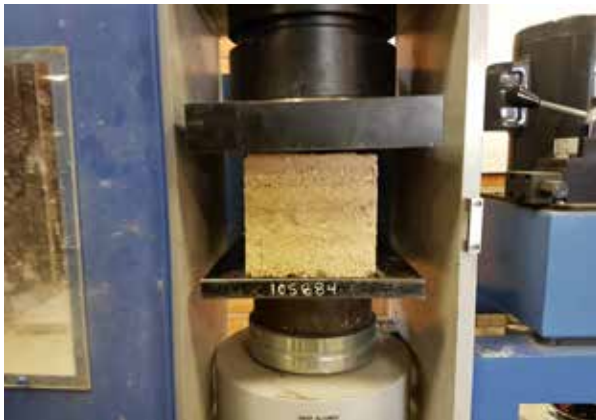
Imagen d8: Sarmiento, I. & Cárdenas, A (2017). Ruptura de muestras a los 28 días de secado. [Fotografía]. Cuenca, Ecuador.
