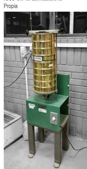
Imagen 73. Colocación de tamices en la tamizadora
