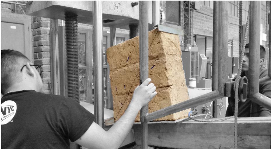
Imagen 101. Colocación del murete en la prensa mecánica
