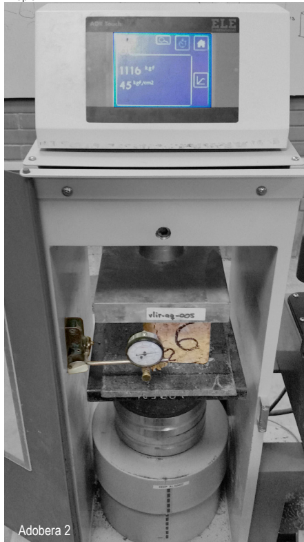
Imagen 89. Esquema de ensayo a compresión en cubo de adobe
