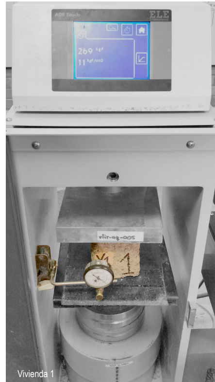
Imagen 89. Esquema de ensayo a compresión en cubo de adobe
