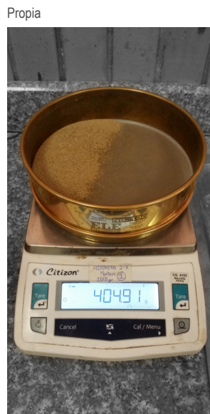
Imagen 74. Peso de tamiz mas la muestra retenida
