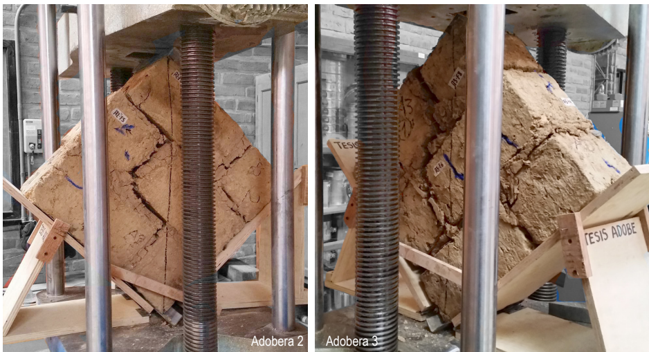
Imagen 102. Murete ensayado a tracción indirecta
