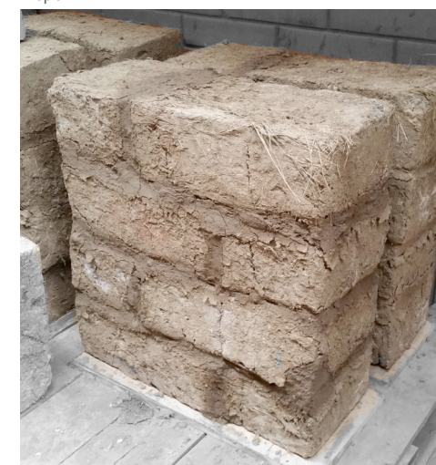
Imagen 100. Murete para ensayo a tracción indirecta de la adobera 1
