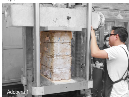
Imagen 98. Aplicación de la carga a compresión
