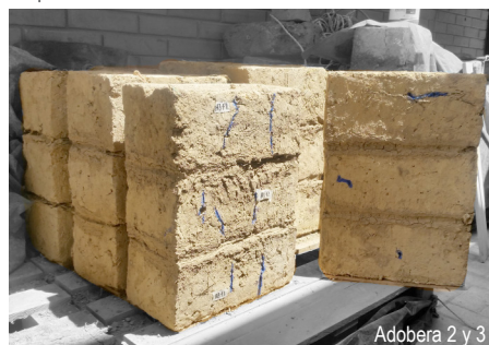
Imagen 95. Murete para ensayar a compresión
