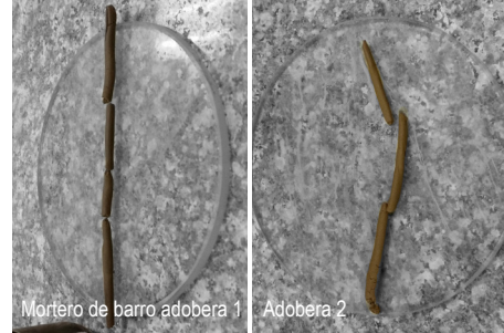
Imagen 83. Comprobando que el rollo se desmorono a los 3.2mm
