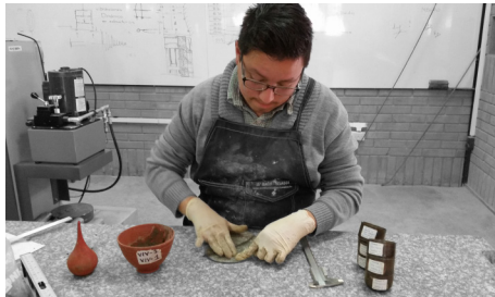
Imagen 83. Comprobando que el rollo se desmorono a los 3.2mm
