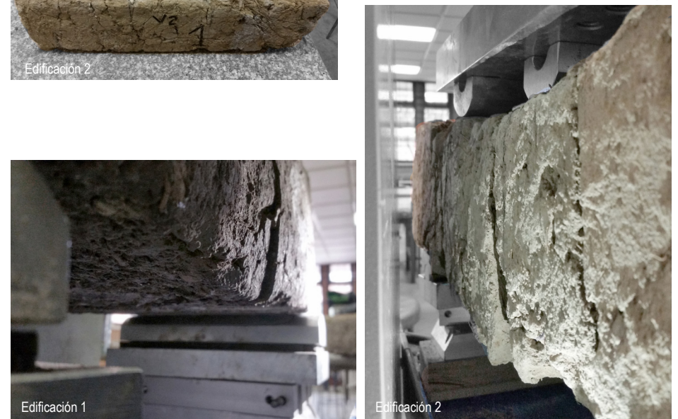
Figura 111. Fisura provocada por las cargas en los tercios
