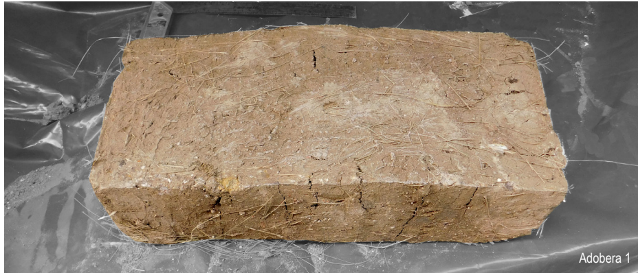
Imagen 38. Torsión y fisuras en el adobe Propio
