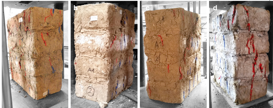
Imagen 57. Muretes ensayados a compresión de la adobera 2 Propia
