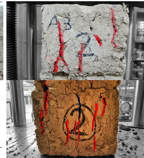
Imagen 54. Fisuras en muretes a compresión Propia
