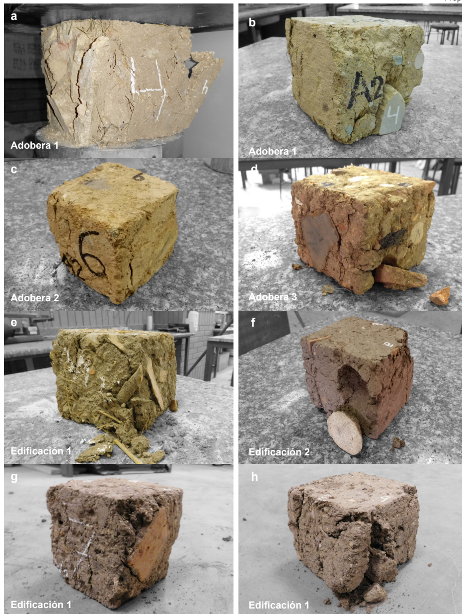
Imagen 50. Cubos de adobe ensayados a compresión
