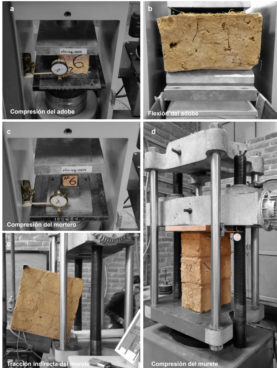
Imagen 49. Ensayos para determinar las características mecánicas
