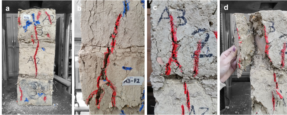
Imagen 56. Muretes ensayados a compresión de la adobera 1 Propia
