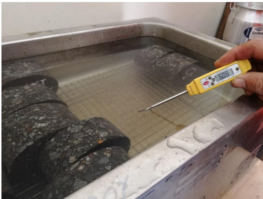
Figura 4-8: Verificación de temperatura de las briquetas para el ensayo Marshall.
