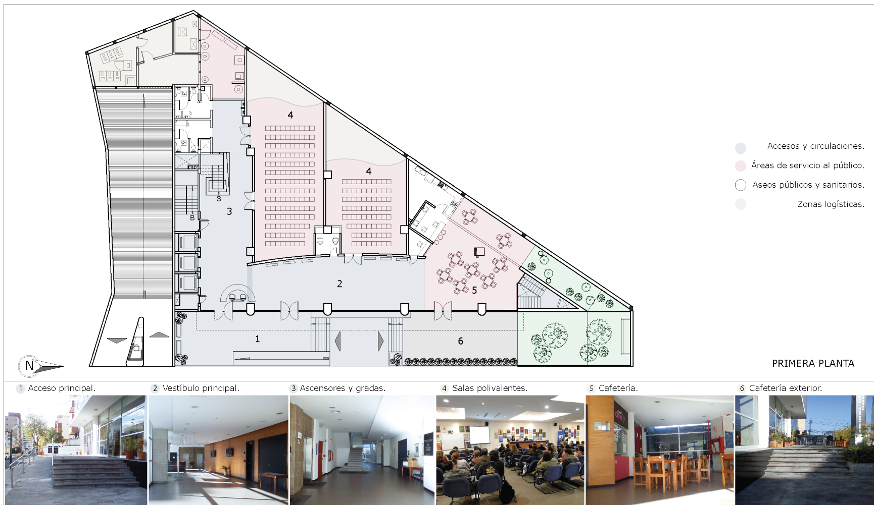
Ilustración 122. Zonificación, de los accesos, circulaciones y áreas de servicio al público. Nelson A. Belduma B., Redibujo (ARQA/EC, 2015).
