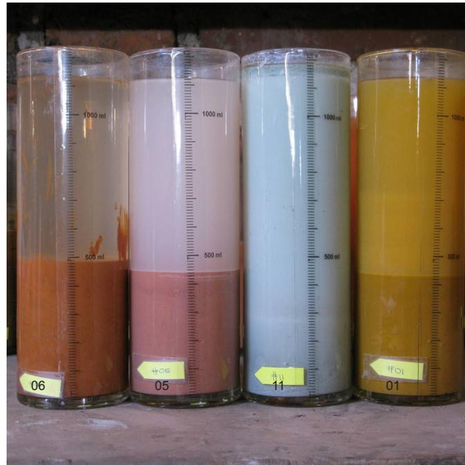
Figura 3.11. Tubos de sedimentación de muestras de suelo seleccionadas para la experimentación. Fuente: Autoras. Año: 2016
