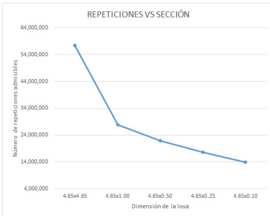
Figura 36: Número de repeticiones admisibles según sección .
