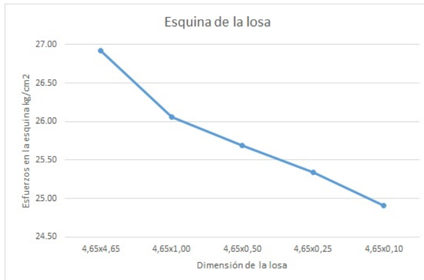
Figura 34: Comparación de esfuerzos en la esquina de la losa.
