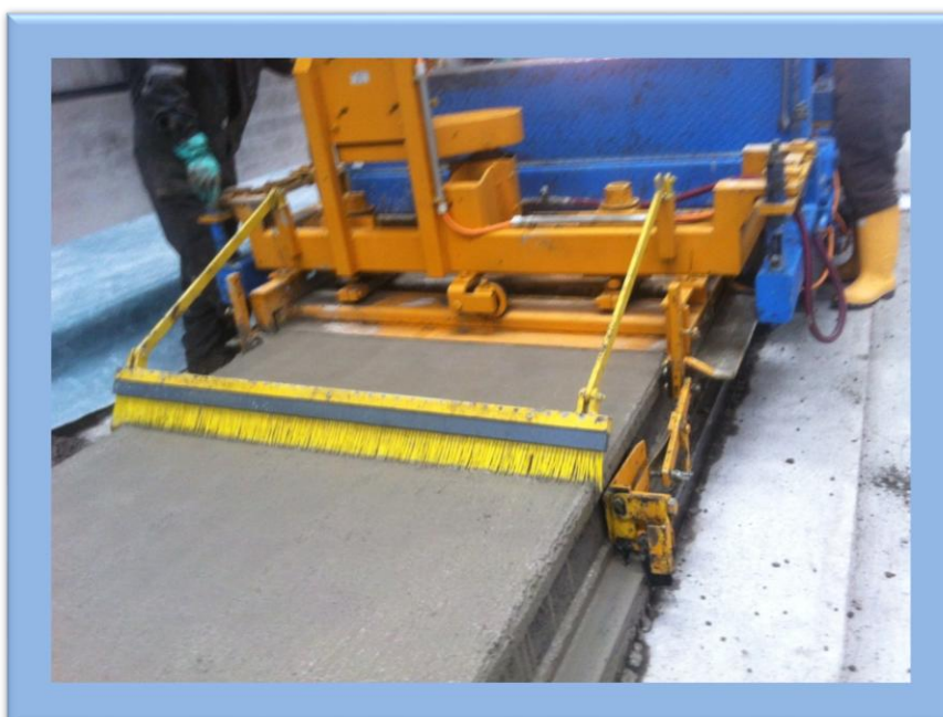
Ilustración 2 Proceso de hormigonado de losa alveolar
