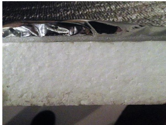
Ilustración 11: Vista lateral del aislamiento térmico del CST de placas planas
