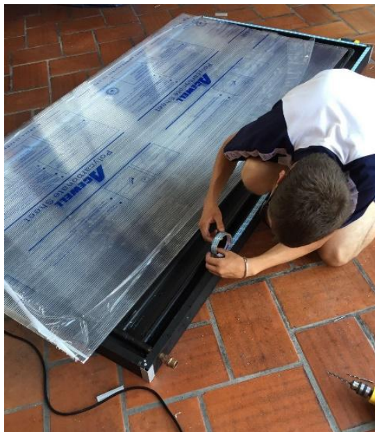
Ilustración 12: Cubierta de policarbonato siendo colocado en el CST de placas planas
