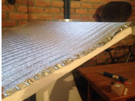
Ilustración 10: Aislamiento térmico del CST de placas planas
