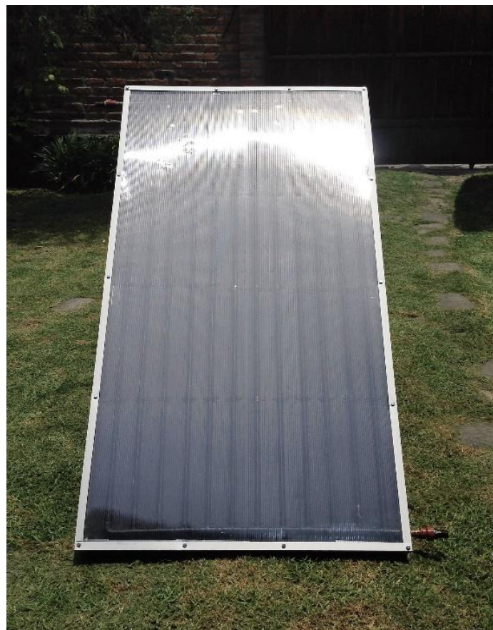
Ilustración 8: Colector solar térmico de placas planas terminado. Fuente: propia
