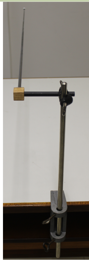
Imagen 11-7. Montaje de la Varilla de longitud.
