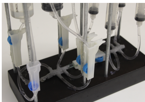
Imagen 12-3. Llaves de paso del fluido.
