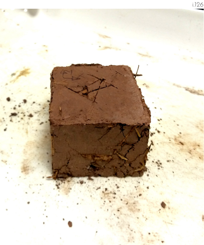
i.124 Gárate, L & Morales, J. (2016). Muestras con Bagazo para ensayar [Fotografía]. Cuenca, Ecuador. i.125 S.n. (s.f). Totorá s.l. [Fotografía]. Recuperado de: http://2.bp.blogspot.com/-_fRZ9dY6L54/UU-EFLUWPiI/AAAAAAAAANOk/XGvVwIByf6U/s1600/Typha+dom.+angust.+Totorá+4.jpg i.126 Gárate, L & Morales, J. (2016). Muestras con Totorá posterior al ensayo de resistencia a la compresión [Fotografía]. Cuenca, Ecuador.
