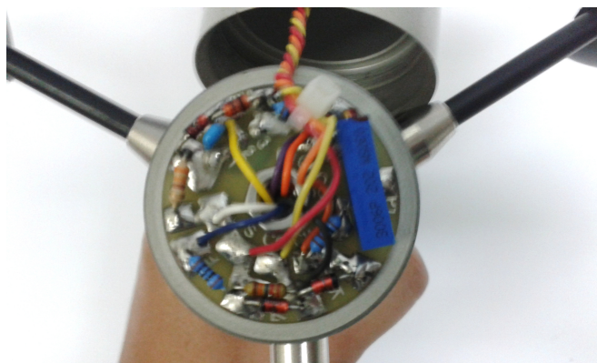
Figura 4.16: Circuito de acondicionamiento para la dirección del viento.
