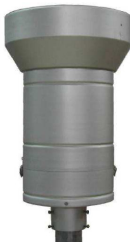
Figura 4.11: Sensor de pluviosidad SIAP+MICROS.
