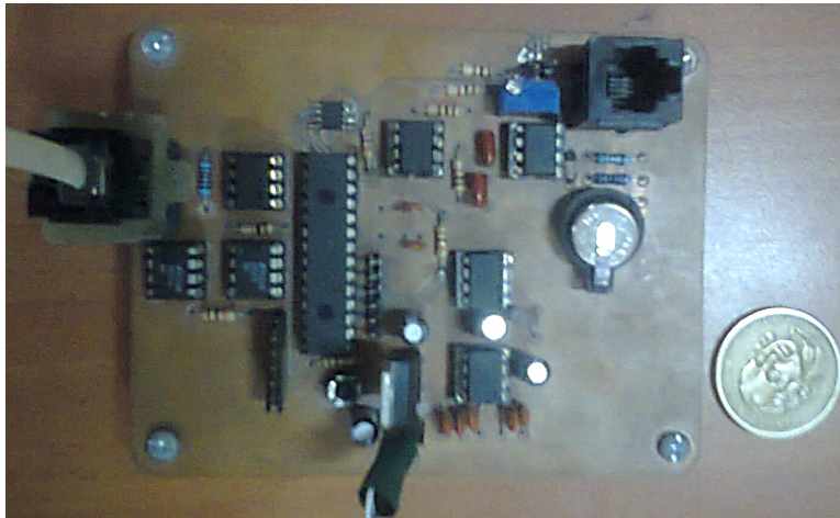
Figura 4.28: Placa esclavo para la captura y procesamiento de datos.
