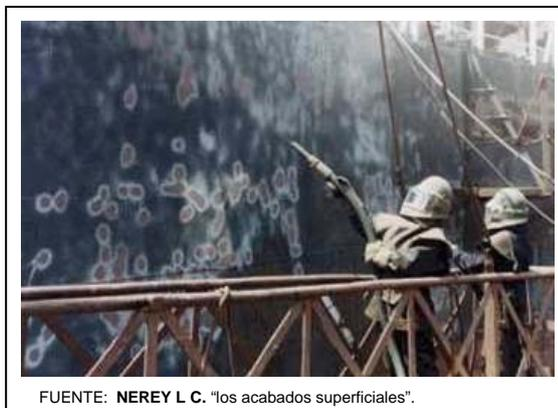
FIG.1.6 - ARENADO DEL CASCO DE UN BARCO DE GRAN CALADO
