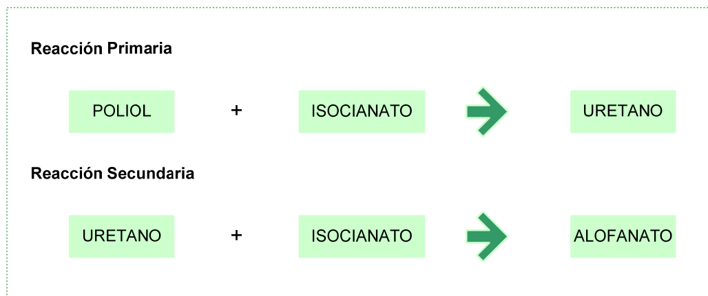
Fig. N° 7: Reacción de Polimerización
