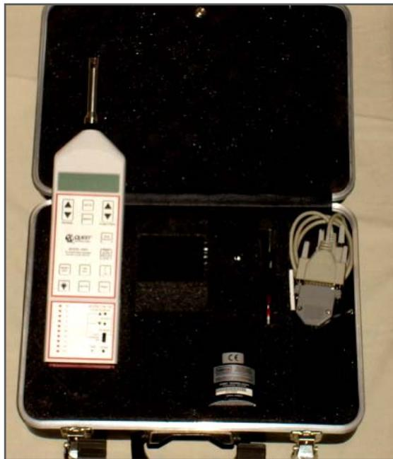
**Fig. N° 6.-** Sonómetro Quest modelo 2900 con su calibrador respectivo.
