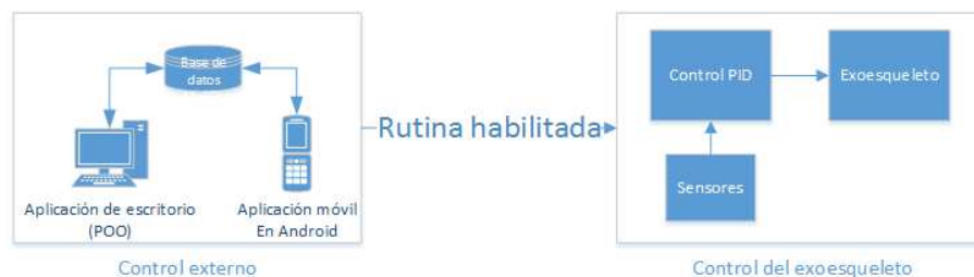
Figura 4.3: Diagrama del sistema de control y gestión del exoesqueleto
