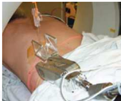
Figura 2.6: Robot asistente en un escaner de registro en una biopsia renal en CT con estructura fiducial. [15]
