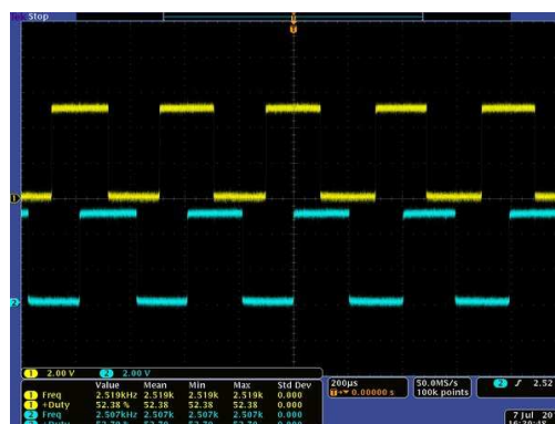
Figura 3.23: Salidas A y B del encoder de cuadratura 5
