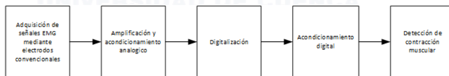
Figura 4.15: Diagrama de bloques para la detección de inicio de contracción muscular
