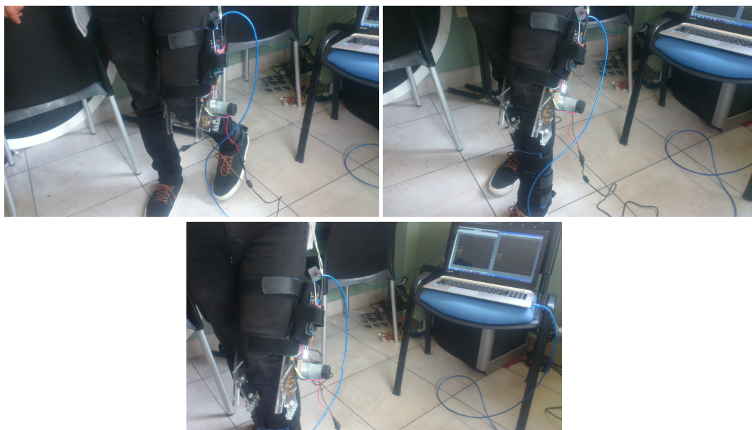
Figura 5.5: Exoesqueleto manteniendo una caminata asistida
