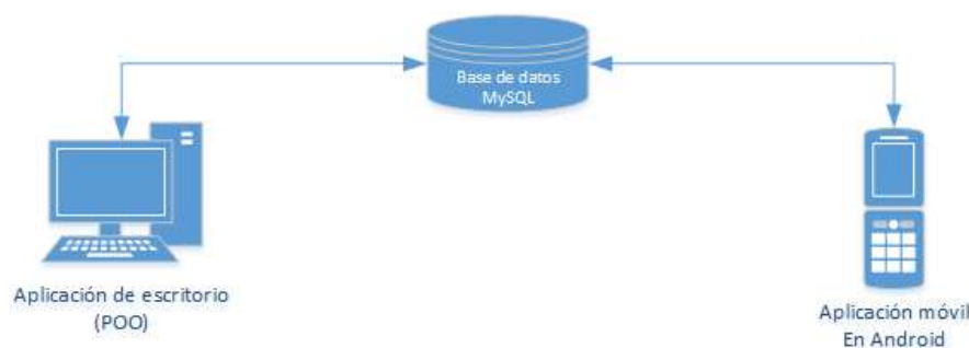
Figura 4.2: Diagrama de comunicación entre la aplicación de escritorio y el smartphone
