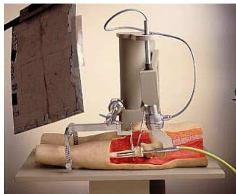
Figura 2.5: Robodoc. Robot diseñado para la cirugía de la cadera y la rodilla 2
