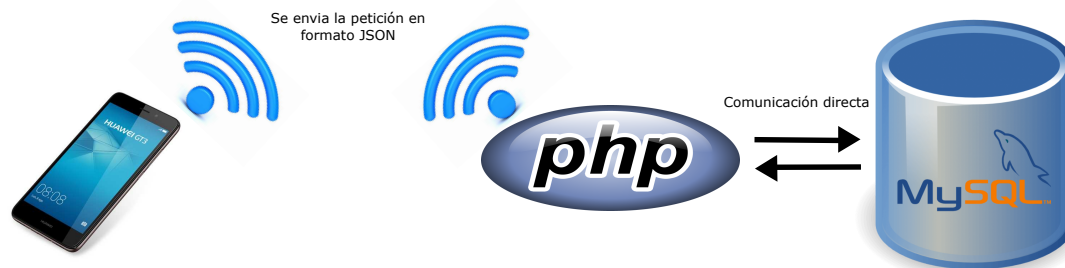
Figura 4.5: Diagrama de funcionamiento SmartPhone-PHP-Base de datos
