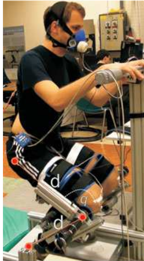
Figura 2.7: Exoesqueleto diseñado para la rehabilitación de la pierna [16]
