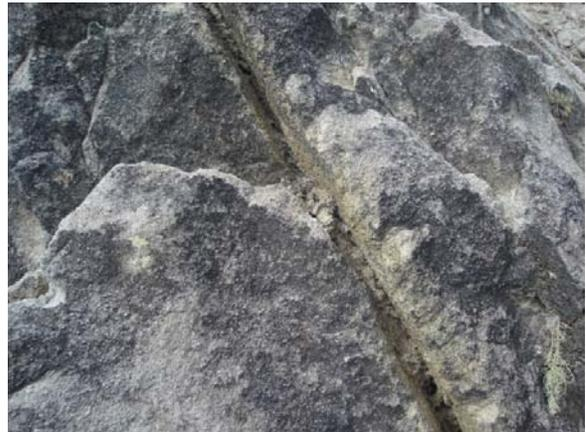
**Foto 2.5: Discontinuidades: Espesor de abertura, relleno.**
