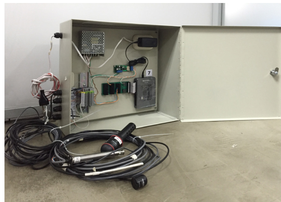
Foto 3.1. Equipo de medición de las variables ambientales. Elaboración propia.
