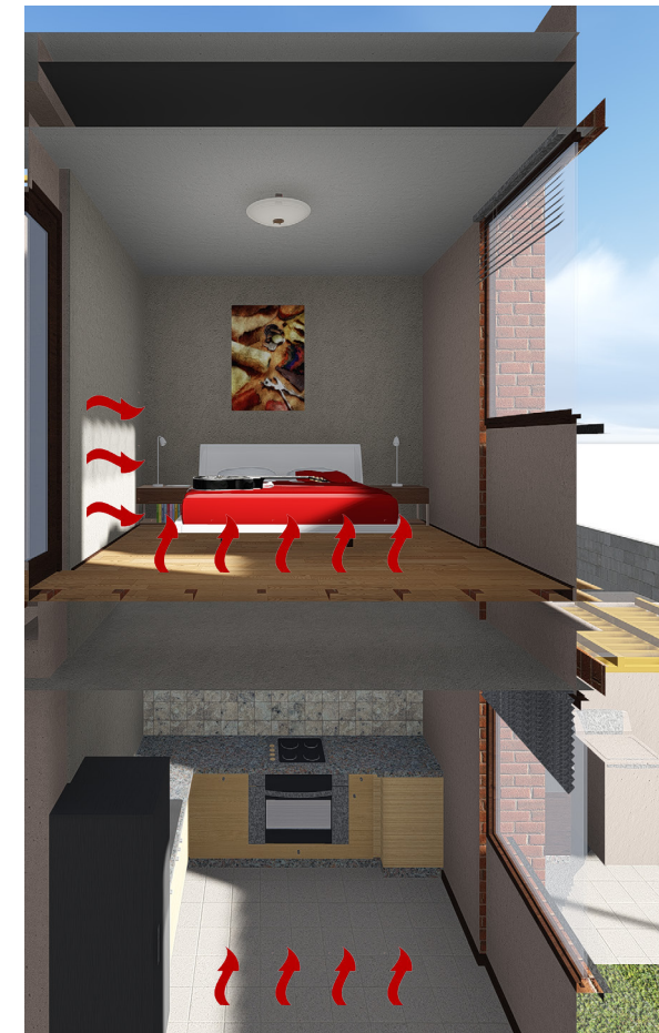
Gráfico 4.48. Esquema de rayos solares en el interior de la vivienda. Elaboración propia.
