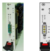
Figura 3.10 PIU de la Estación Base BreezeMAX. (Alvarion).
