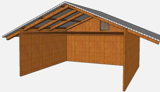
Imagen 135: Cubierta zinc con prolongación de aleros, ventilación compuesta por cámara de aire con dos ventanillas y aberturas en la base.
