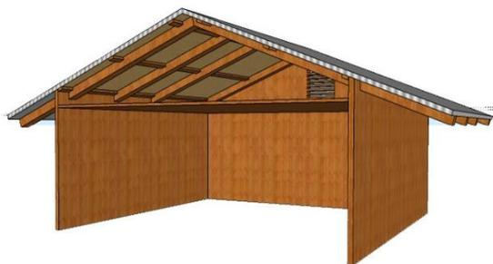
Imagen 136: Cubierta zinc con prolongación de aleros, paja de arroz como aislante térmico interior y cámara de aire ventilada.
