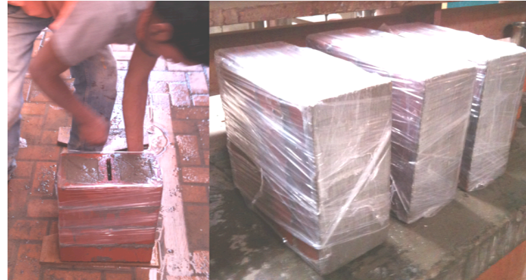
Figura 114. Curado de muretes por medio del emplasticado. Laboratorio de ingeniería. Fotos: el autor.2012.
