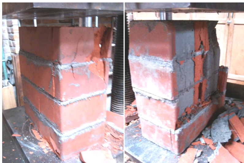
Figura 112. Ensayos de compresión de muretes con y sin las celdas rellenas, en la prensa del laboratorio de ingeniería. Foto: el autor. 2012.
