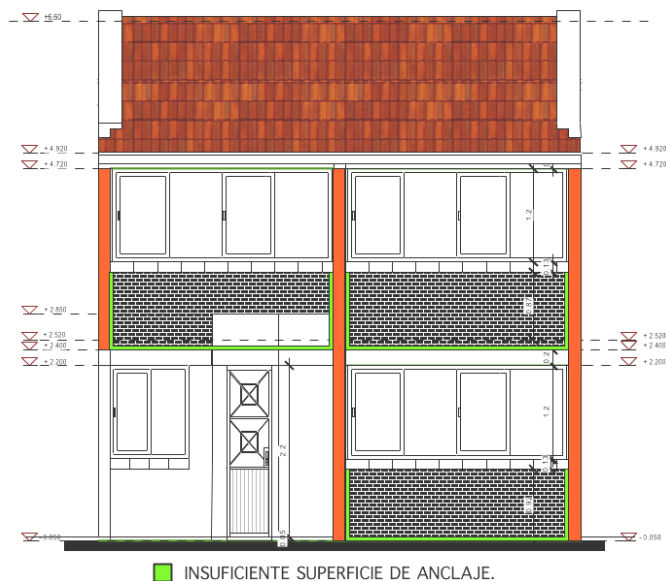
Figura 63. Deficiente anclaje de paredes de antepechos Los Nogales. Fachada frontal. Fuente: El Autor. 2012.
