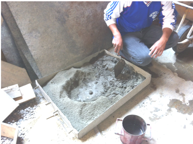
Figura 99. Proceso de preparación del Mortero de Pega. Laboratorio de Ingeniería de la Universidad de Cuenca. Fuente: El Autor. 2012.
