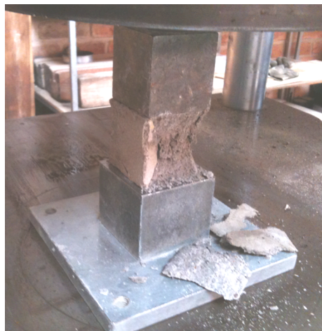
Figura 101. Ensayo a compresión de mortero de pega de cubos de 5 x 5 Cm. Laboratorio de Ingeniería de la Universidad de Cuenca. Fuente: El Autor. 2012.
