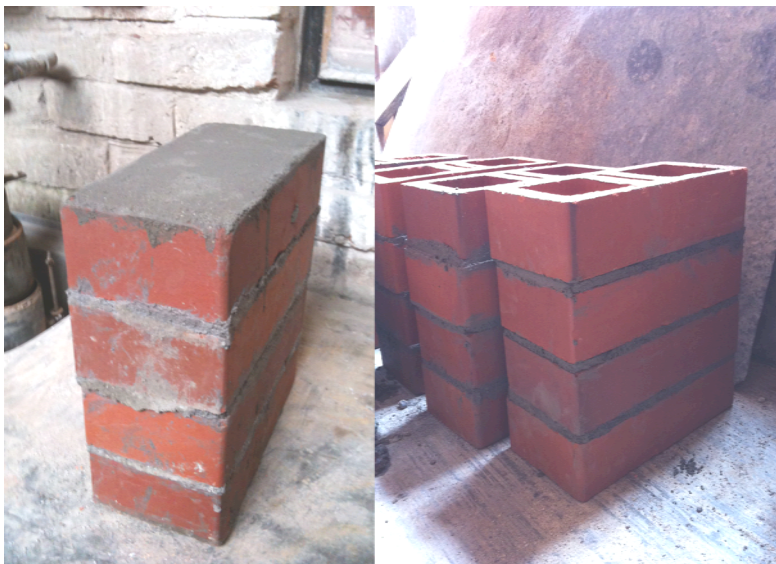
Figura 111. Elaboración de muretes, con celdas rellenas y con celdas vacías. Laboratorio de ingeniería de la universidad de Cuenca. Foto: el autor. 2012.
