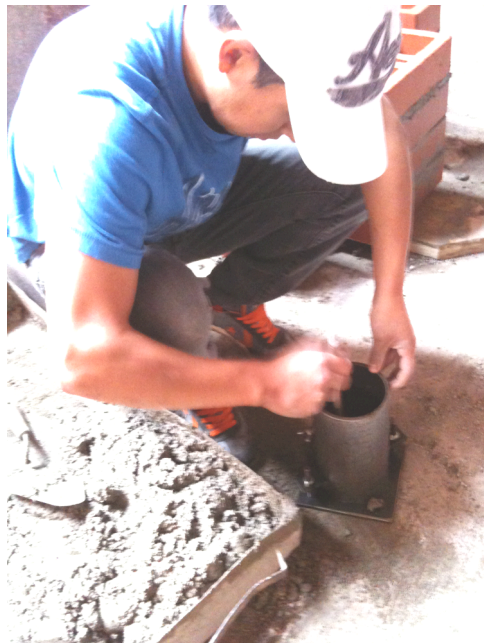
Figura 104. Preparación de mortero de relleno, para colocación en cilindros de 75cm de diámetro por 150cm de altura, para ensayo a compresión de mortero de relleno, Laboratorio de Ingeniería de la Universidad de Cuenca. Fuente: El Autor. 2012.
